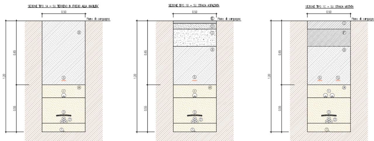
**Figura 4: Tipologico cavidotto sez: 1A, 1B e 1C**
