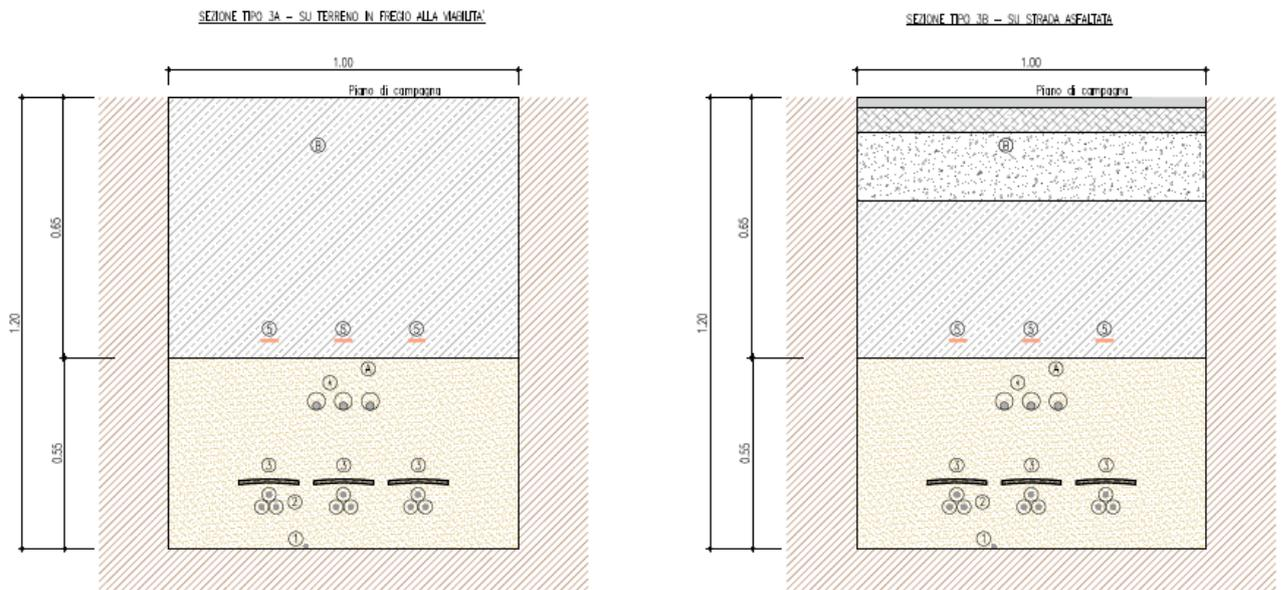
**Figura 6: Tipologico cavidotto sez: 3A e 3B**
