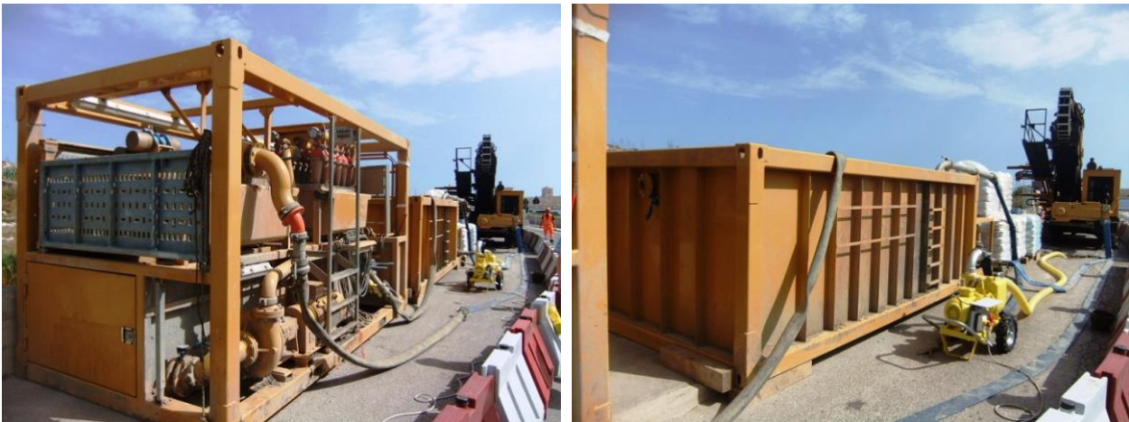
Figura 20 – Unità recupero fanghi
