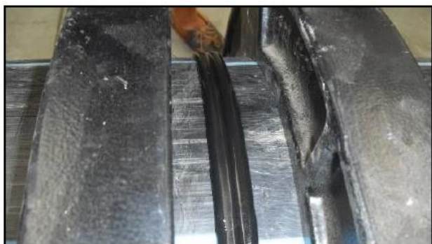
Macchina per termofusione e aspetto finale a saldatura avvenuta
