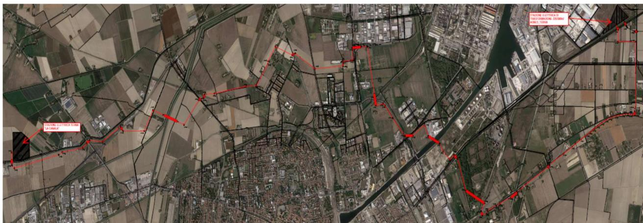
Figura 89: Planimetria generale del tracciato elettrodotto in cavo interrato 380kV
