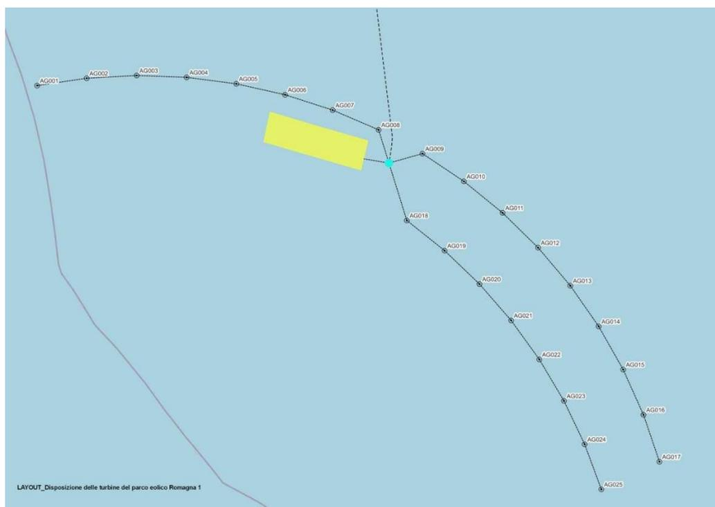
Figura 19: Posizionamento degli aerogeneratori di Romagna 1
