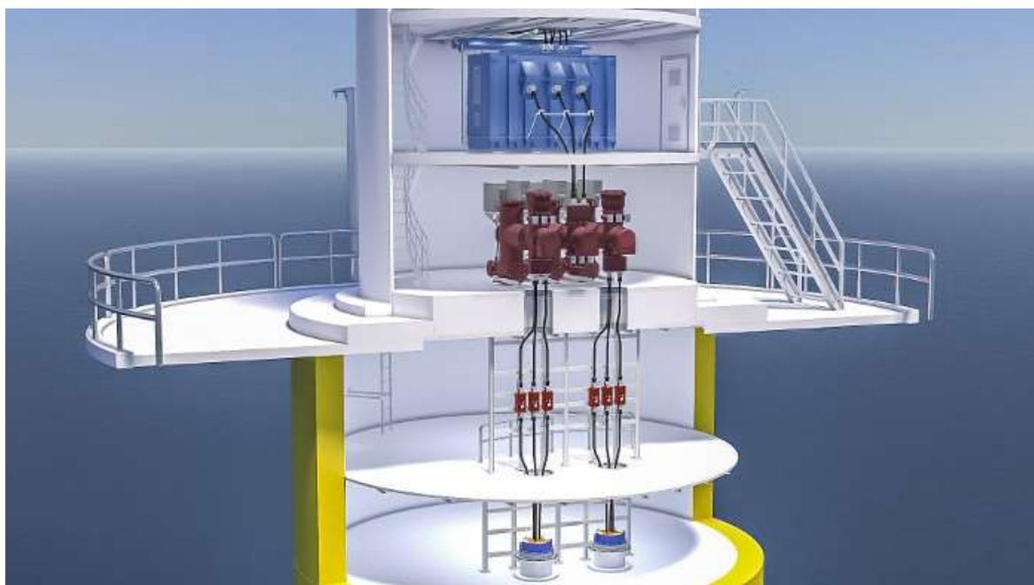
Figure 26: Trasformatore, GIS, connettori e hang-off
