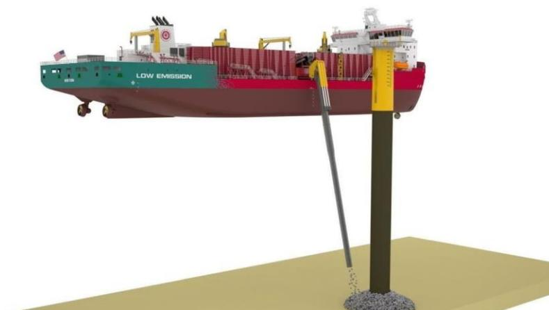
Figura 66: Esempio installazione di scour protection
