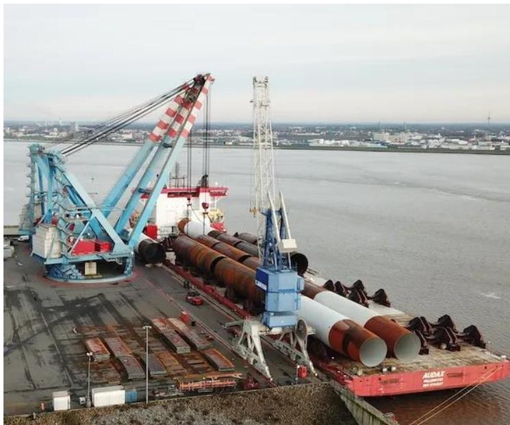
Figura 51: Operazioni di carico della nave HLV con fondazioni monopalo
