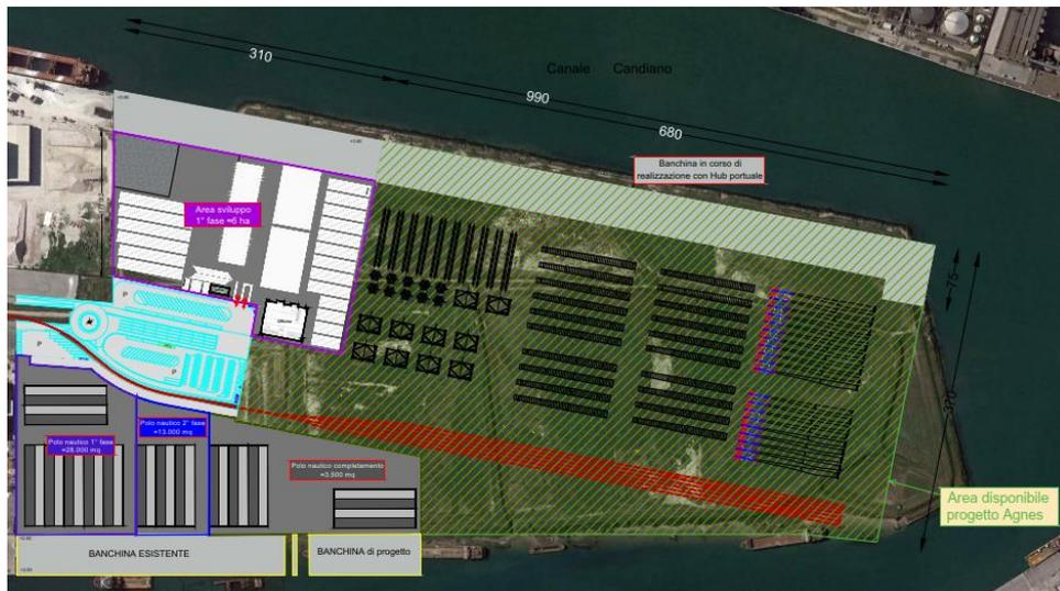
Figura 47: Ipotesi di stoccaggio: torri e pale in posizione orizzontale, componenti multipala, jacket in posizione verticale
