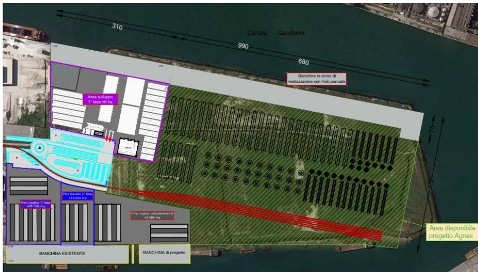
Figura 41: Ipotesi di stoccaggio: monopali e componenti multipalo in posizione orizzontale, elementi di transizione in posizione verticale
