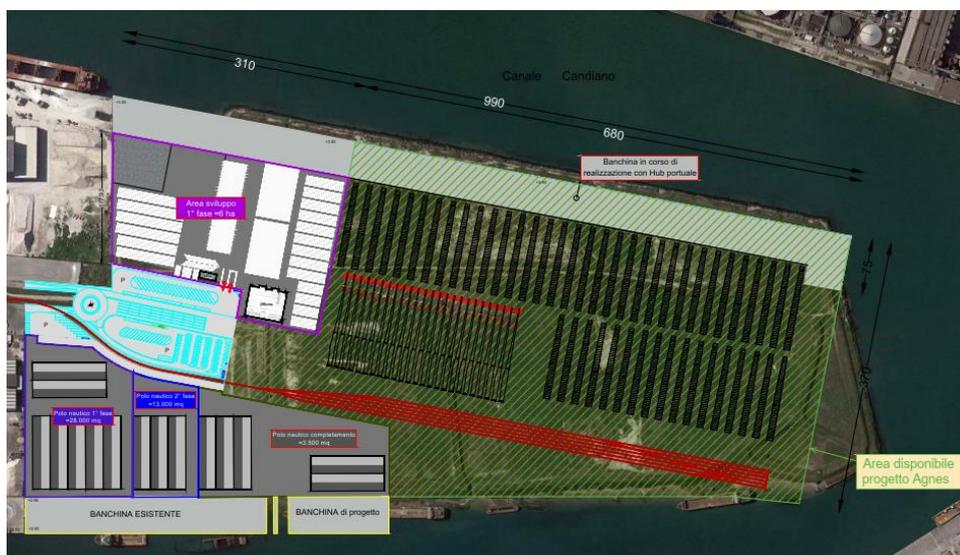
Figura 49: Ipotesi di stoccaggio: torri e pale in posizione orizzontale
