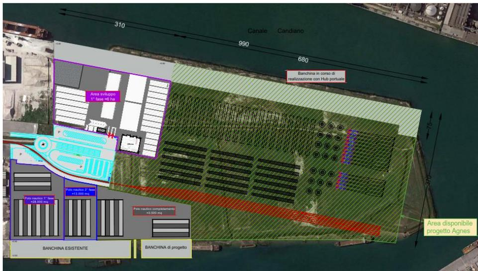
Figura 42: Ipotesi di stoccaggio: monopali, torri e pale in posizione orizzontale, elementi di transizione in posizione verticale
