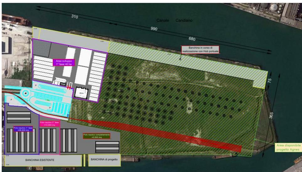
Figura 46: Ipotesi di stoccaggio: monopali ed elementi di transizione in posizione verticale
