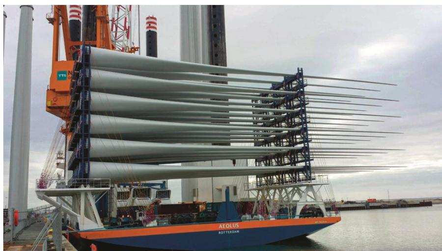
Figura 60: Fase di carico in porto. Vista del supporto per il trasporto delle pale
