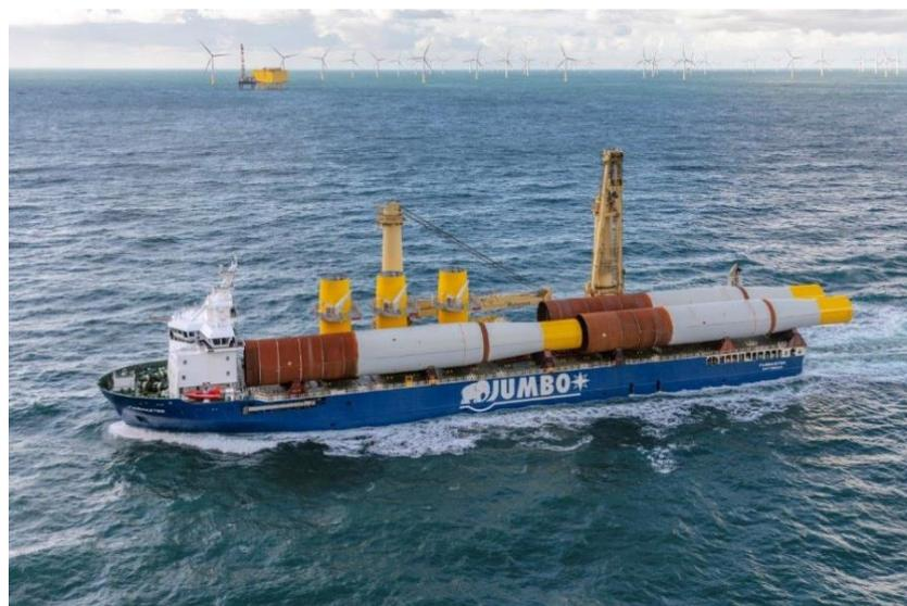
Figura 54: Nave HLV con monopali ed elementi di transizione fissati sul ponte della nave
