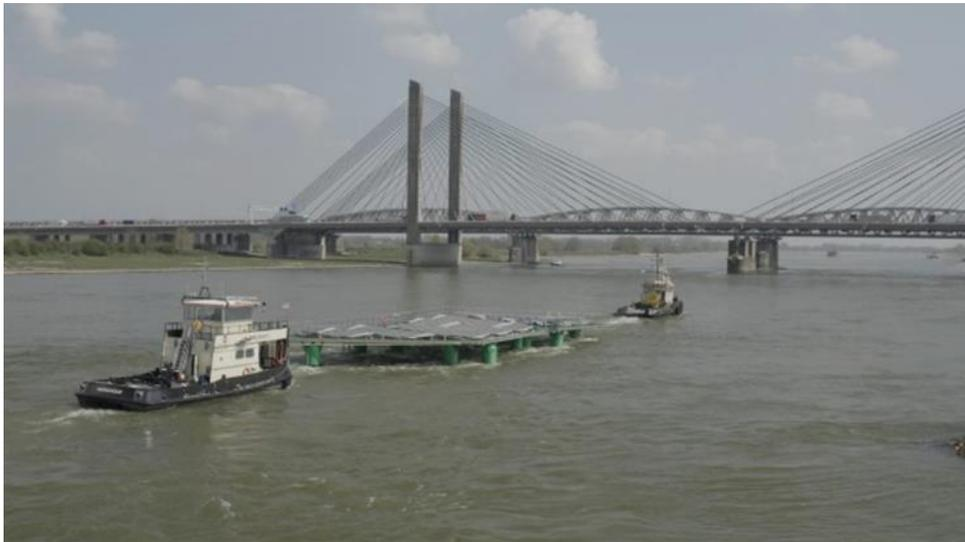
Figura 19: Trasporto piattaforma triangolare tramite rimorchiatori
