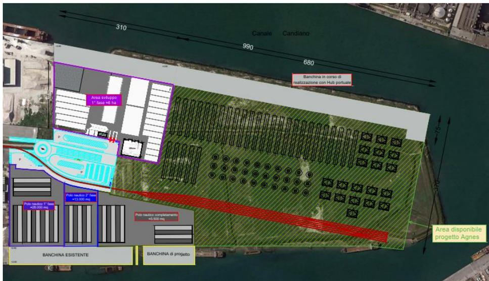
Figura 40: Ipotesi di stoccaggio: monopali in posizione orizzontale, jacket ed elementi di transizione in posizione verticale
