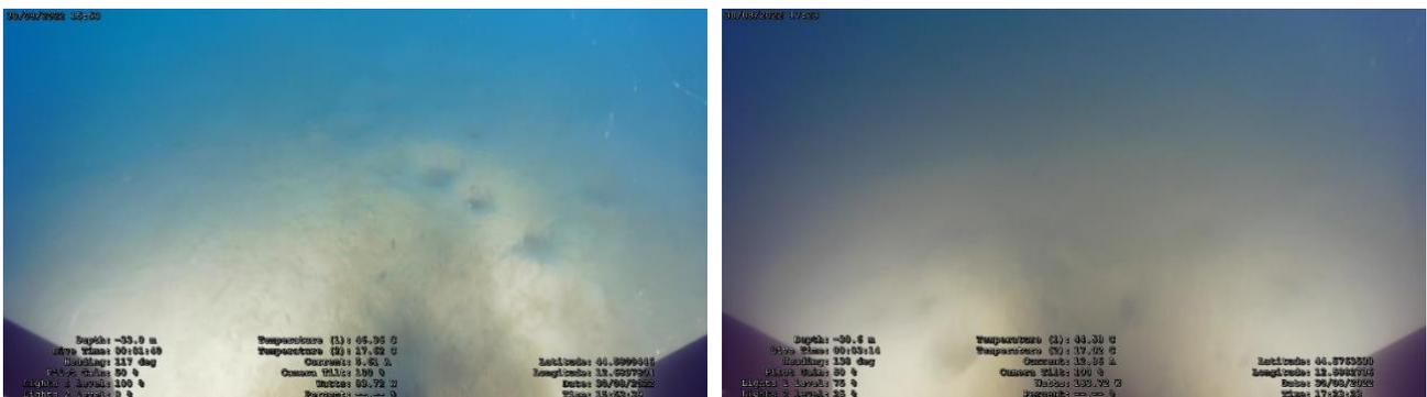
Figura 39: Fondali incoerenti di natura siltosa e segni di bioturbazione sui target ispezionati.
