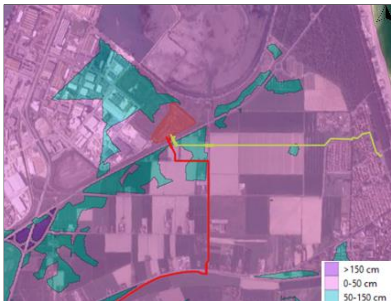
Figura 6.1: Mappa di tiranti idrici nell'area di studio relativa all'area costiera. Il poligono rosso individua l'area "Agnes Ravenna Porto"; i tracciati giallo e rosso indicano rispettivamente i cavi terrestri 220kV e 380kV
