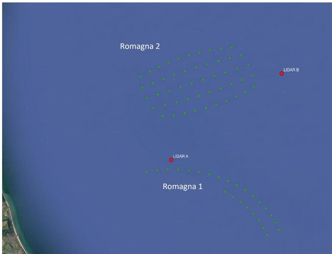
Figura 10: Ubicazione dei device lidar per la misurazione del vento nel sito di Progetto
