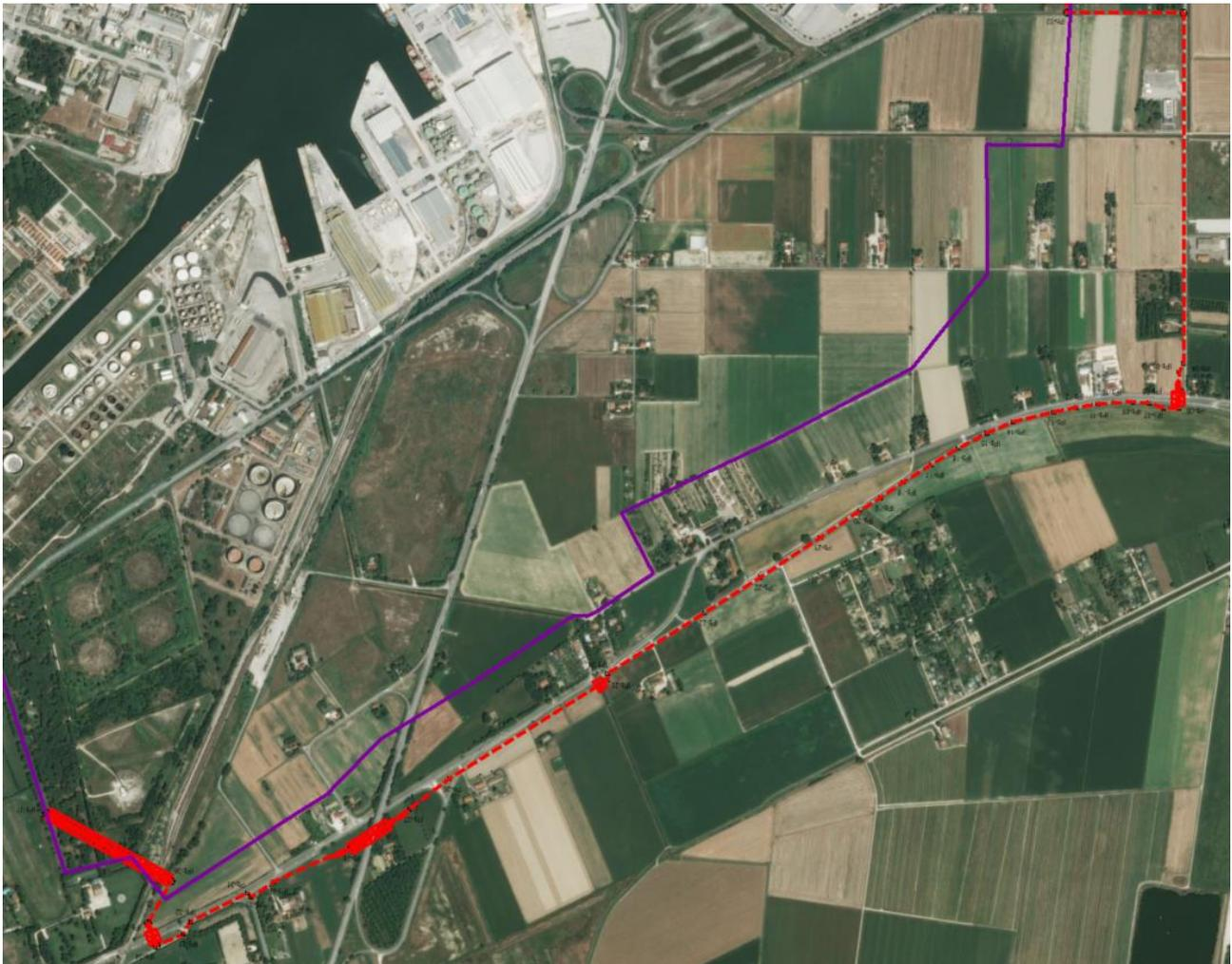
Figura 4.17: Tracciato selezionato elettrodotto in cavo interrato 380 kV – Variante 1
