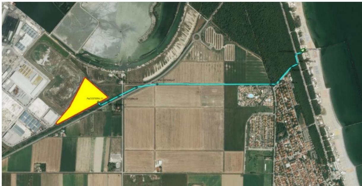
Figura 4.3: Ipotesi di tracciato elettrodotta in cavo interrato 220 kV – Ipotesi “Costiera”
