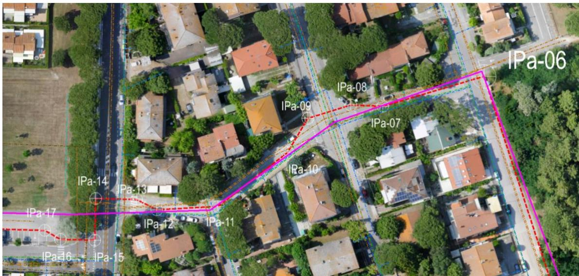
Figura 4.5: Tracciato selezionato elettrodotta in cavo interrato 220 kV – Variante 1
