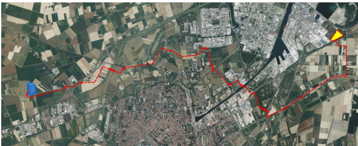
Figura 4.23: Tracciato selezionato elettrodotta in cavo interrato 380 kV
