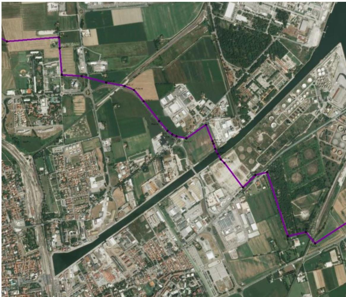
Figura 4.15: Tracciato selezionato elettrodotti in cavo interrato 380 kV – Sezione 2 (Ipotesi “B”)
