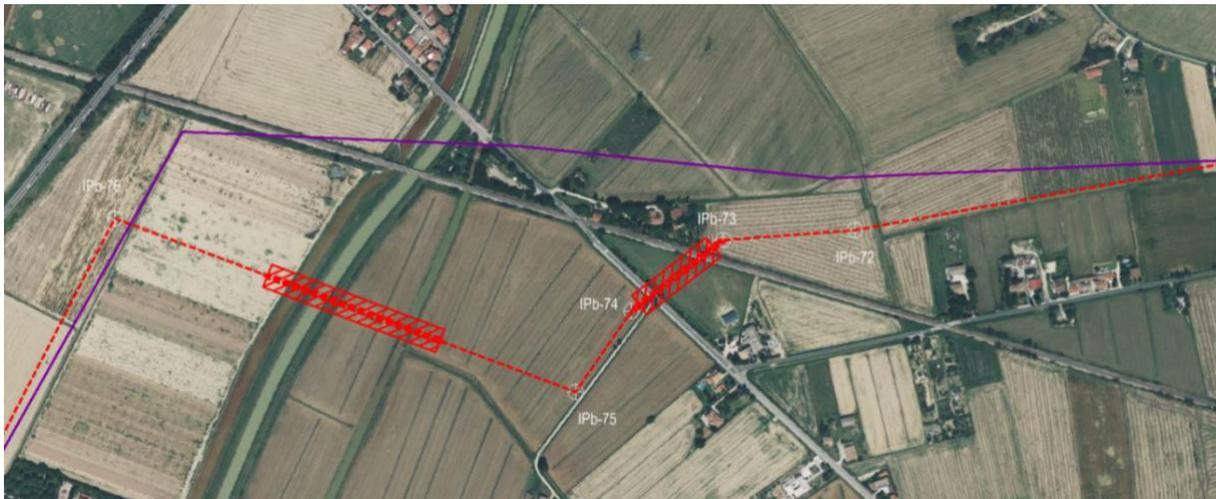
Figura 4.22: Tracciato selezionato elettrodotta in cavo interrato 380 kV – Variante 4
