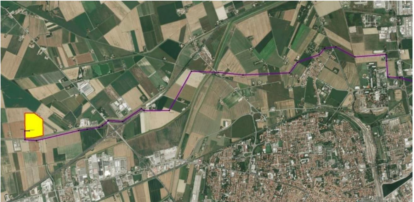
Figura 4.16: Tracciato selezionato elettrodotta in cavo interrato 380 kV – Sezione 3 (Ipotesi “B”)
