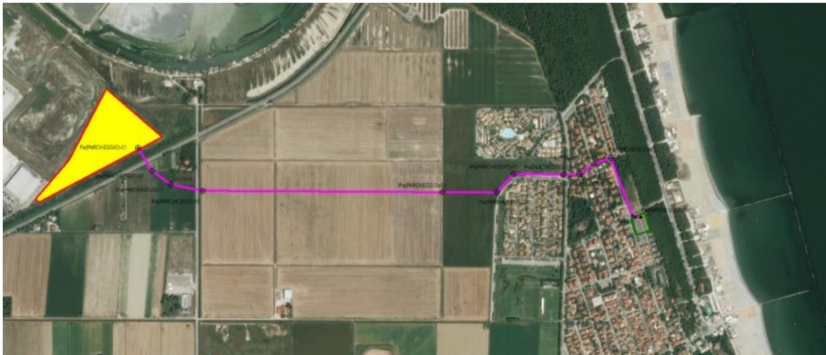
Figura 4.4: Ipotesi di tracciato elettrodotta in cavo interrato 220 kV – Ipotesi “Parcheggio”
