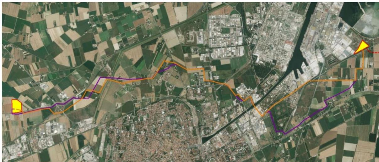
Figura 4.8: Ipotesi di tracciato elettrodotto in cavo interrato 380 kV
