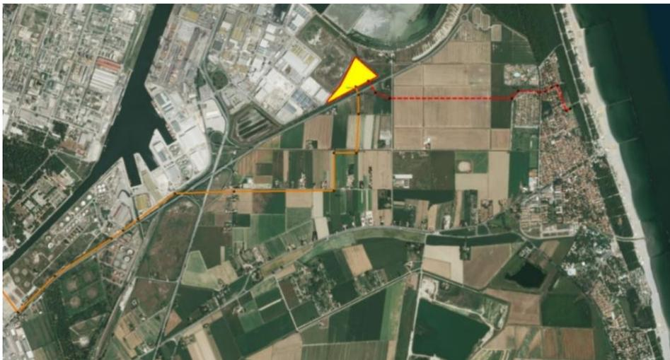
Figura 4.10: Tracciato selezionato elettrodotta in cavo interrato 380 kV – Sezione 1 (Ipotesi "A")
