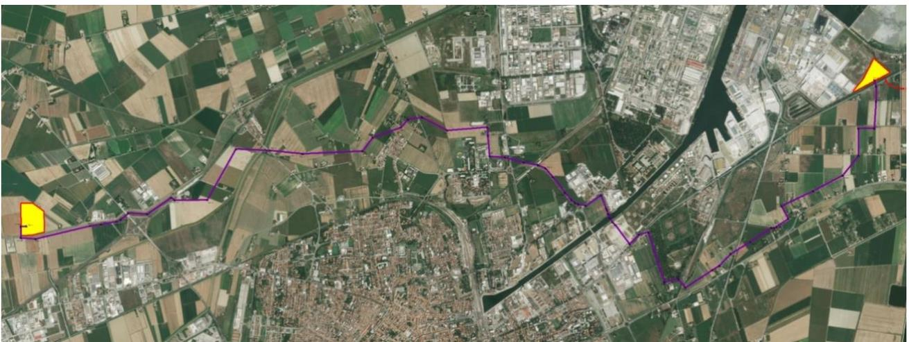
Figura 4.13: Ipotesi di tracciato elettrodotta in cavo interrato 380 kV – Ipotesi “B”
