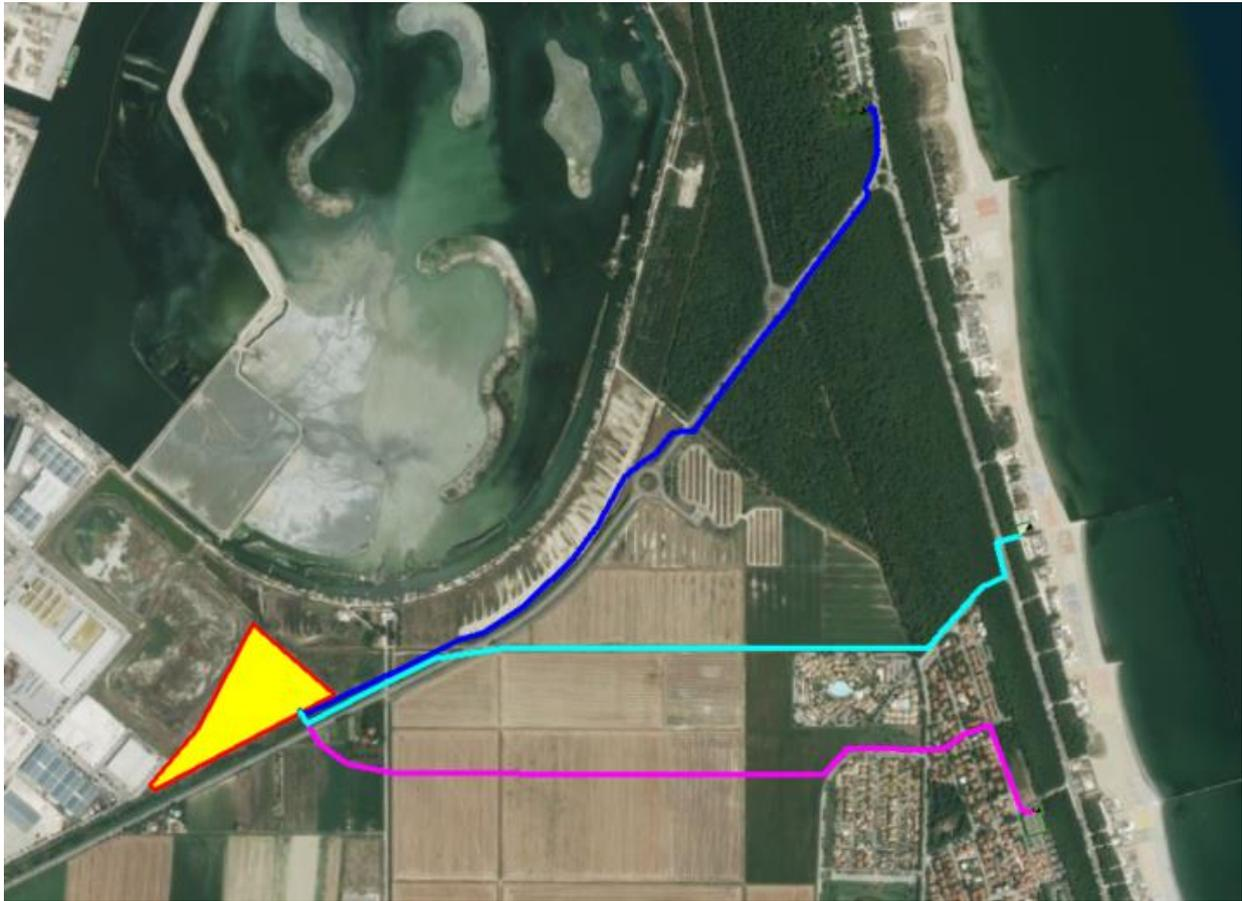
Figura 4.1: Ipotesi di tracciato elettrodotta in cavo interrato 220 kV
