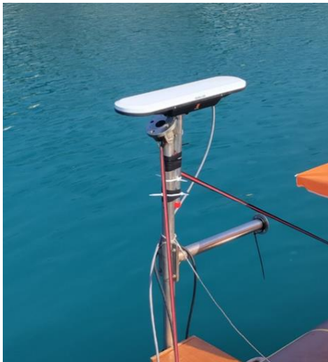
Figura 26- Antenna del sistema di posizionamento SeaNav (a sinistra); Beacon USBL montato sul ROV (a destra).
