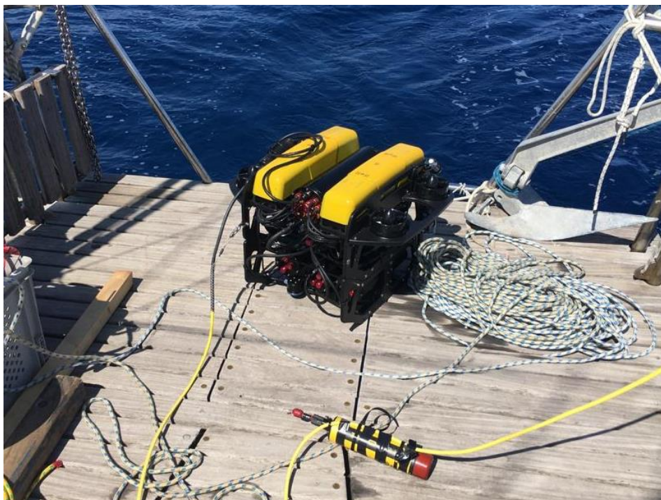
Figura 37- ROV adoperato con beacon USBL assicurato all'ombelicale.
