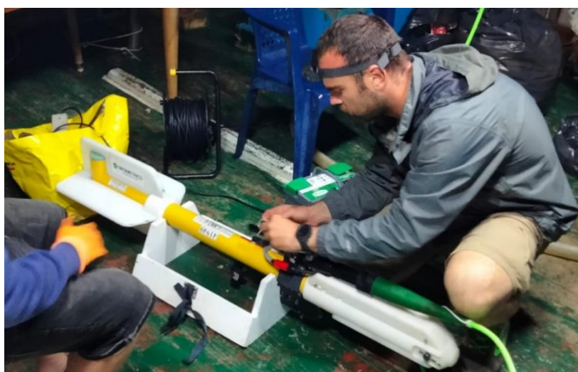
Figura 35– Fasi di preparazione del magnetometro prima del rilievo.
