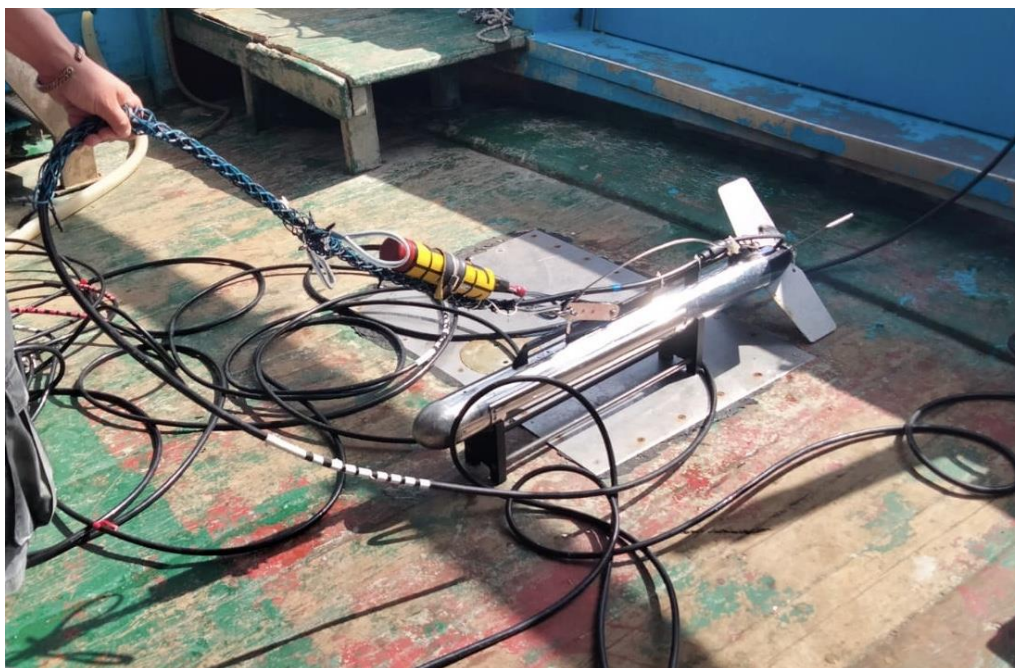
Figura 31– Beacon USBL posizionato sul cavo del Side Scan Sonar a circa 1 m dal towfish.
