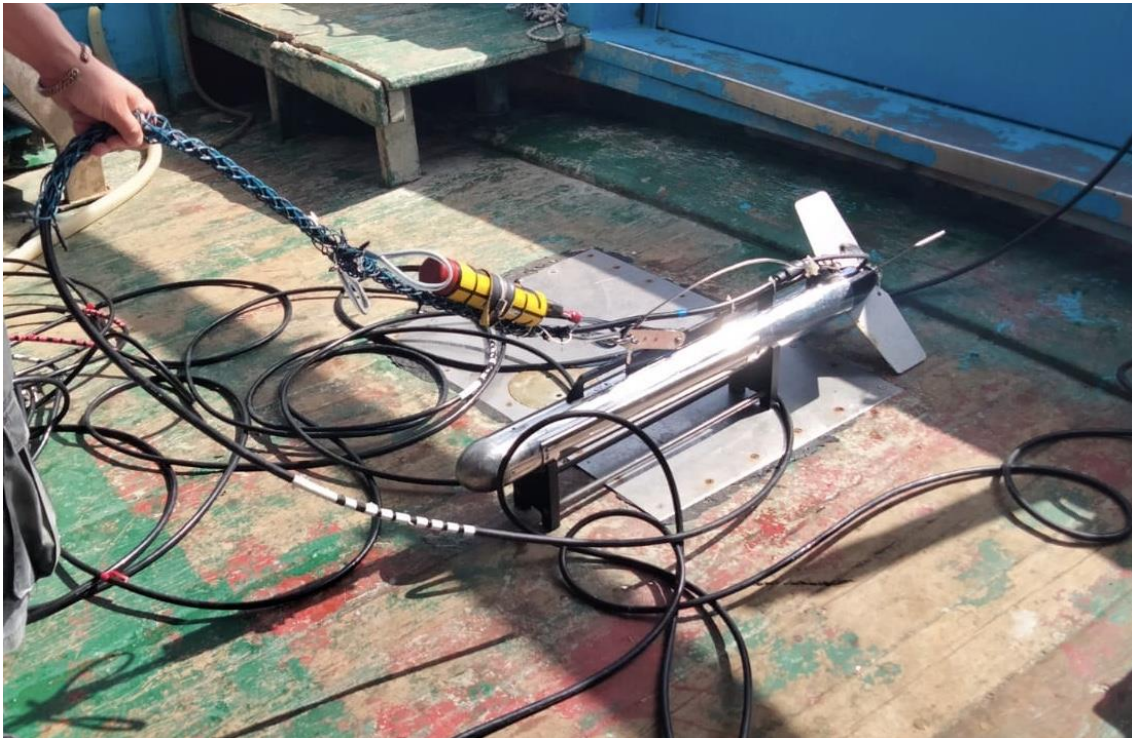
Figura 17– Transponder USBL installato sul cavo armato del Side Scan Sonar.
