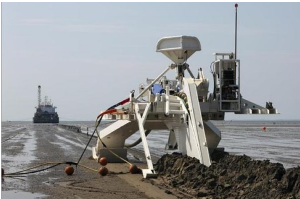
Figura 22: immagine esempio di un Plough
