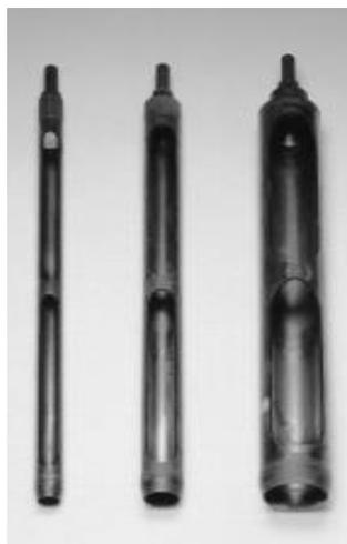
Figura 7.2: Carotieri utilizzati
