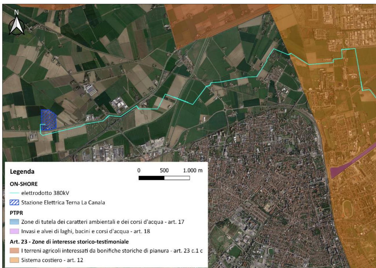
Figura 20: Mappa dei vincoli individuati dal PTPR per la porzione di territorio interessata dal percorso degli elettrodotti 380 kV in arrivo alla Stazione Terna La Canala (fonte: Elaborazione Qgis su cartografia digitale PTPR)
