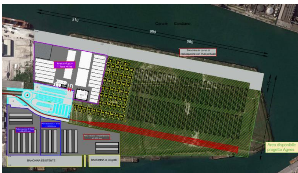
Figura 99: Ipotesi di stoccaggio 50 monopali e 50 elementi di transizione in posizione orizzontale
