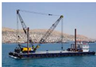
b) Crane barge
