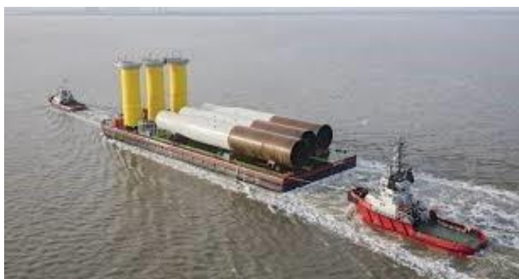
Figura 102: Chiatte per il trasporto di fondazioni monopalo ed elementi di transizione
