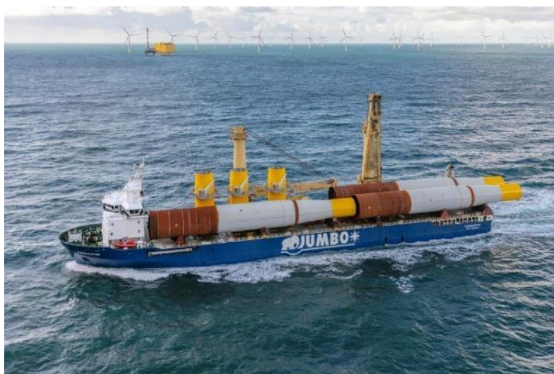
Figura 104: Nave HLV con monopali ed elementi di transizione fissati sul ponte della nave
