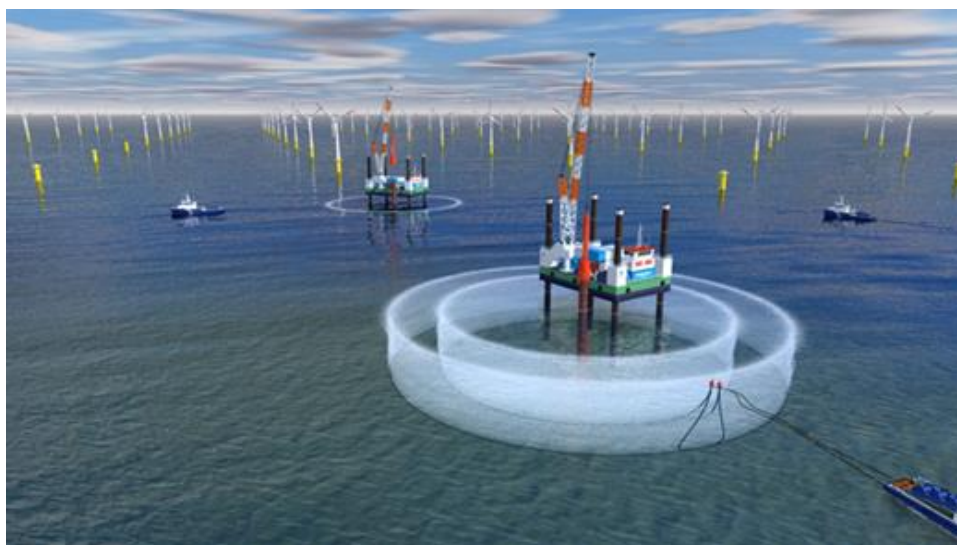
Figura 106: Schematica di esempio: Bubble curtain grande durante operazioni di installazione
