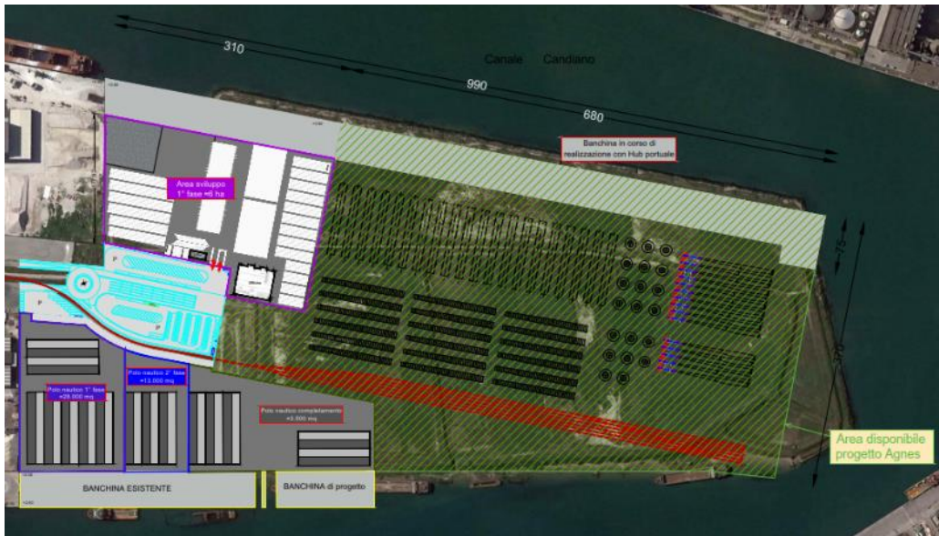
Figura 100: Ipotesi di stoccaggio monopali, torri e pale in posizione orizzontale, elementi di transizione in posizione verticale
