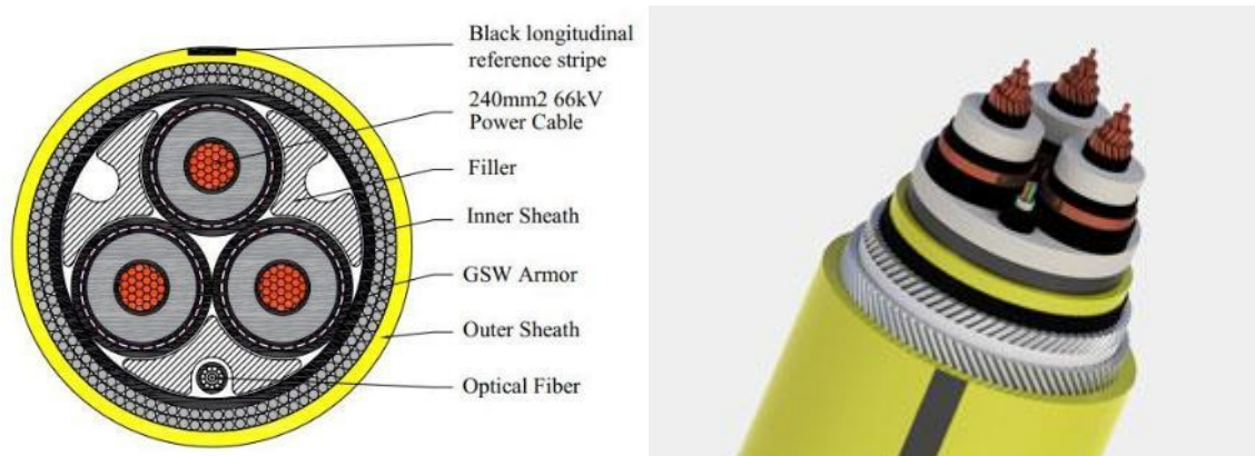
Figura 66: Stratigrafia Cavo dinamico
