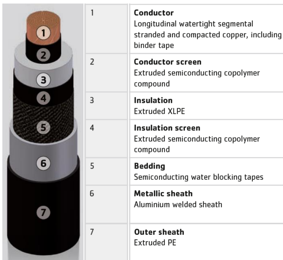
Figura 97: Esploso della composizione del cavo 380kV
