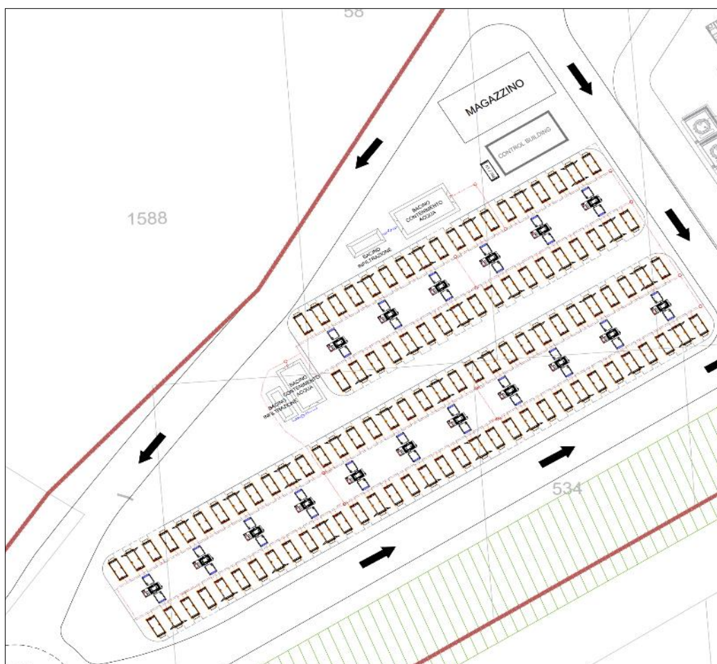
Figura 91: Planimetria dell'impianto di accumulo
