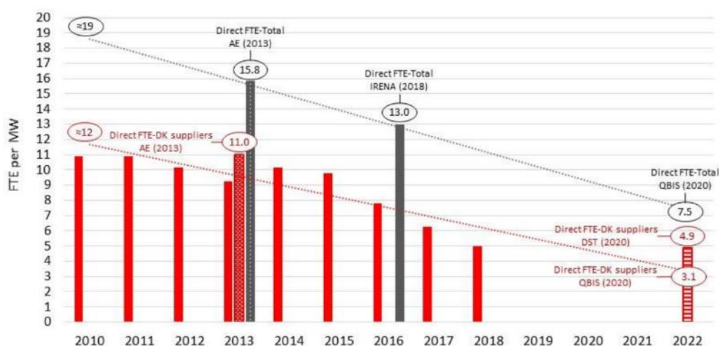
Figura 7: Trend delle risorse a tempo piene utilizzate per MW nell'eolico offshore in Europa
