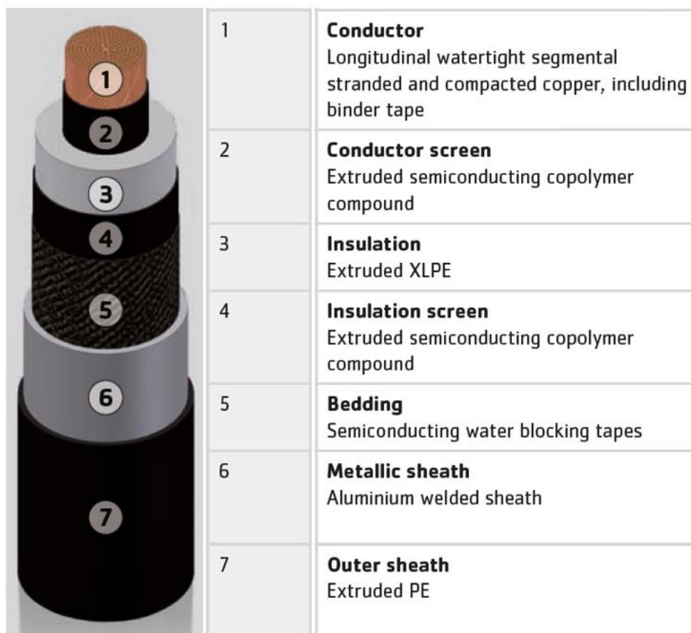
Figura 86: Esploso della composizione del cavo 220 kV
