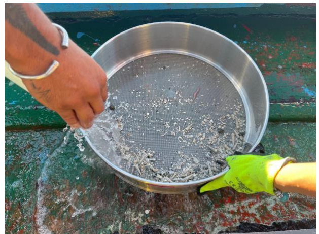
Dettaglio del setaccio a maglia di 0,5 mm durante la fase di setacciatura del campione.
