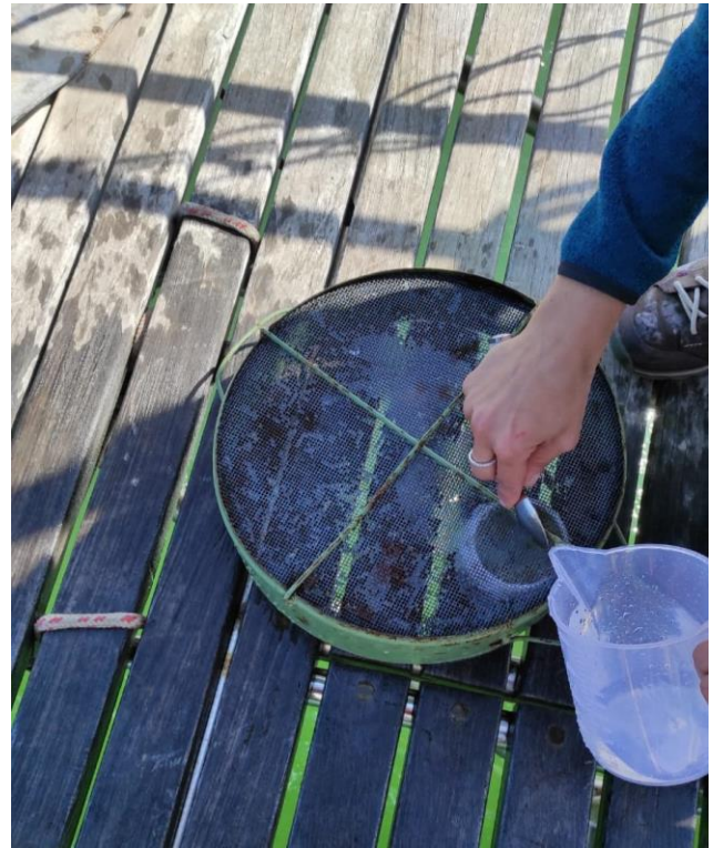
Raccolta del campione di microplastiche a seguito del campionamento con retino Manta.
