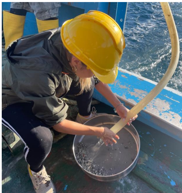
Fase di setacciatura del campione mediante setaccio a maglia di 0,5 mm.
