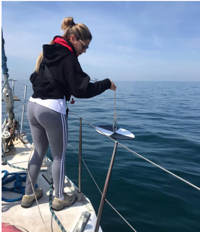
Misurazione della trasparenza dell'acqua con impiego di disco Secchi.
