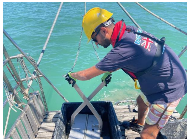
Tecnico intento alle operazioni di movimentazione della Benna Van Veen da 18 L sull'imbarcazione Joshua.
