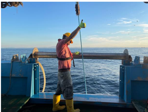
Tecnico intento alle operazioni di movimentazione della Benna Van Veen da 18 L sull'imbarcazione Marianna.
