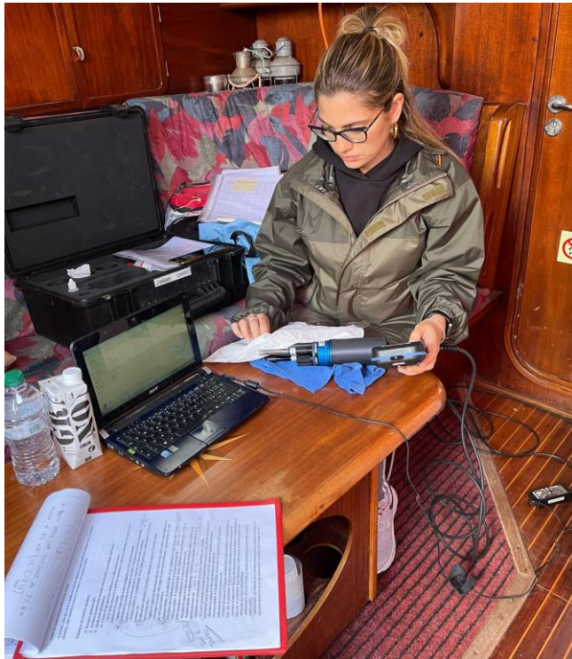
Operazioni di calibrazione della sonda multiparametrica.
