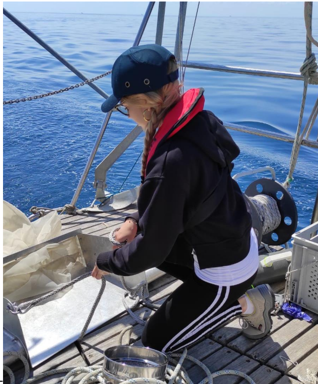
Preparazione del retino Manta per il campionamento di microplastiche flottanti.
