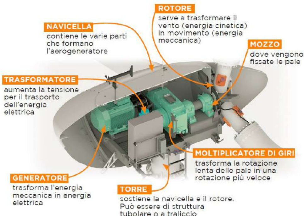
Figura 1 – Struttura aerogeneratore – Fonte ANEV (Associazione Nazionale Agenzia del Vento)
