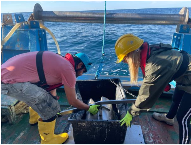
Tecnici durante una delle fasi di movimentazione della benna Van Veen da 18 L sull'imbarcazione Marianna.
