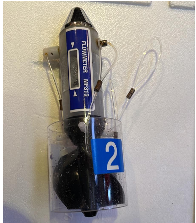
Flussimetro utilizzato per il calcolo della distanza percorsa durante il campionamento dello zooplancton.
