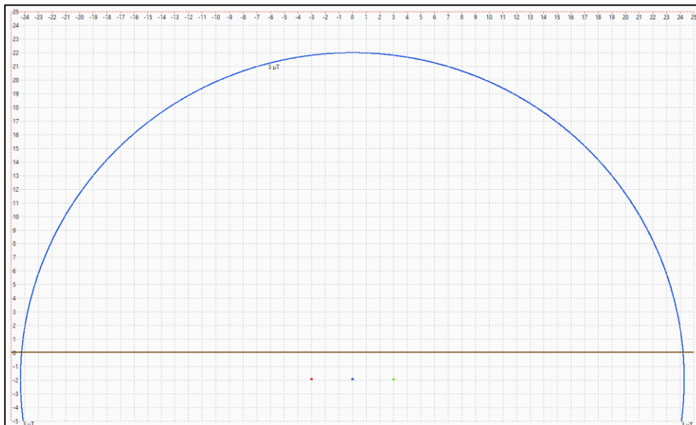
Figura 10: Curva isolivello del campo magnetico a 3 \mu T in una sezione longitudinale alla configurazione di posa descritta in Figura 9. Buca giunti
