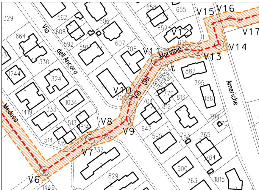
Figura 19: analisi delle potenziali criticità lungo l'elettrodotto 220 kV.
