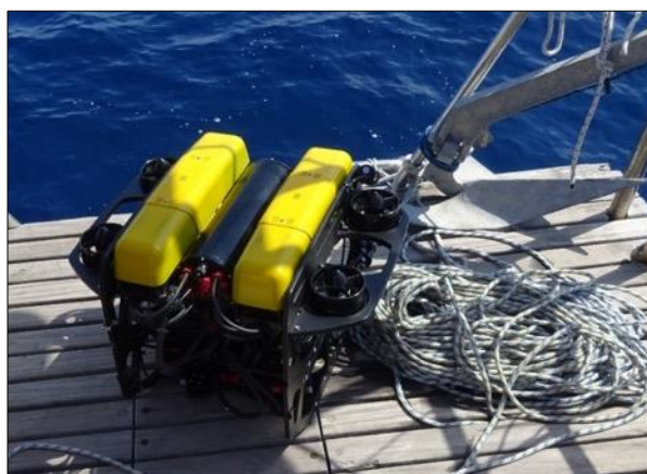
Figura 1.14: Il sistema ROV utilizzato per le ispezioni
