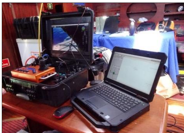
Figura 1.15. La postazione di guida e controllo del ROV
