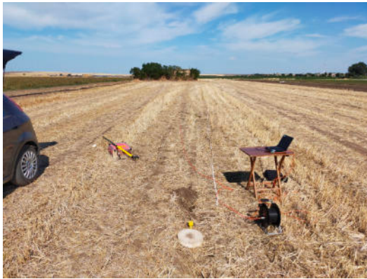
Indagine sismica Holisurface HS5 e misura di microtremori HVSR5
