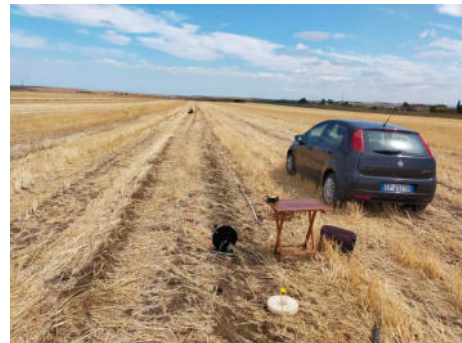
Stendimento sismico MASW2 e sismica a rifrazione R2 HoliSurface HS2
