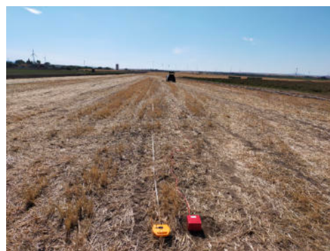
Indagine sismica HoliSurface HS4 e misura di microtremori HVSR4
