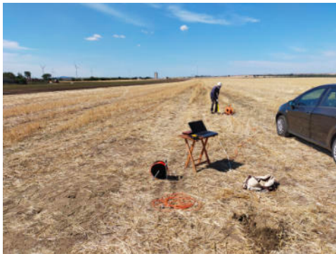
Stendimento sismico MASW1 e sismica a rifrazione R1, HoliSurface HS1
