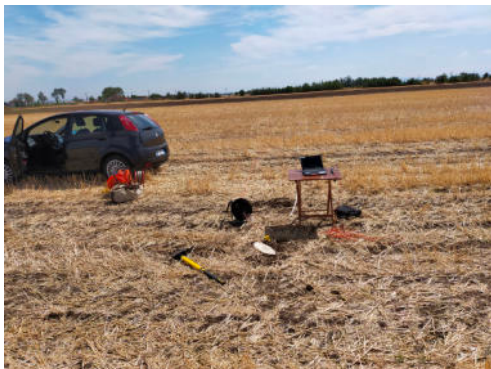
Indagine sismica HoliSurface HS3 e misura di microtremori HVSR3
