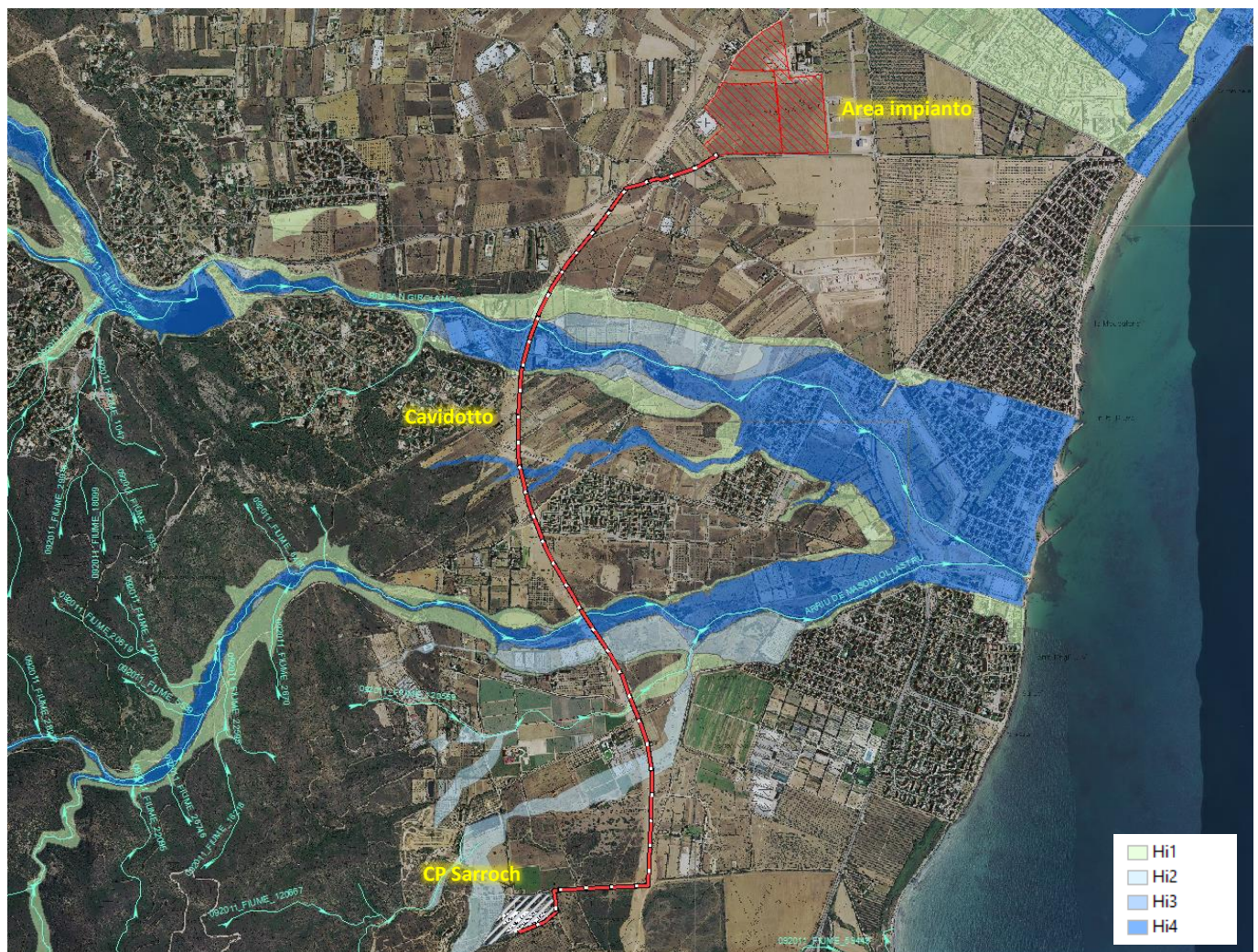
Figura 10.2 - Inquadramento PAI dell'area interessata dal cavidotto di connessione alla sottostazione CP Sarroch.
