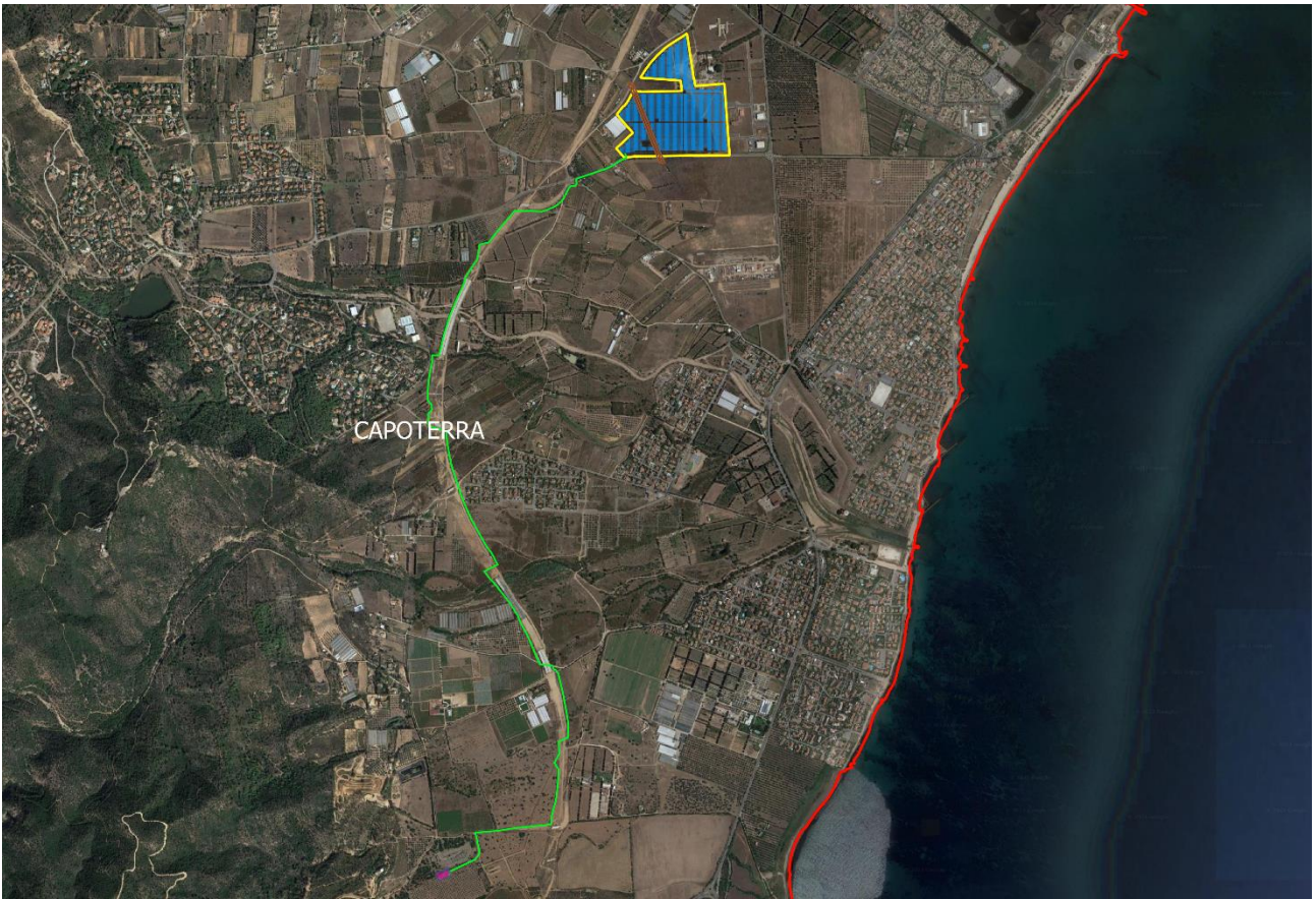
Fig. 5.2 – Impianto, cavidotto e Sottostazione Elettrica Utente (SSEU)
