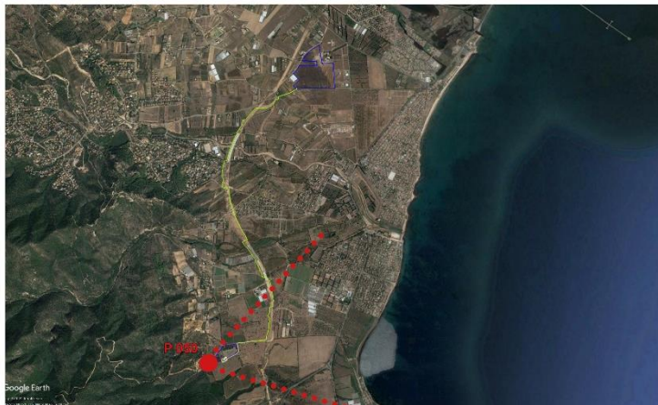
Cono visivo - In blu l'area di impianto in proposta e della SE, in verde il percorso del cavidotto
