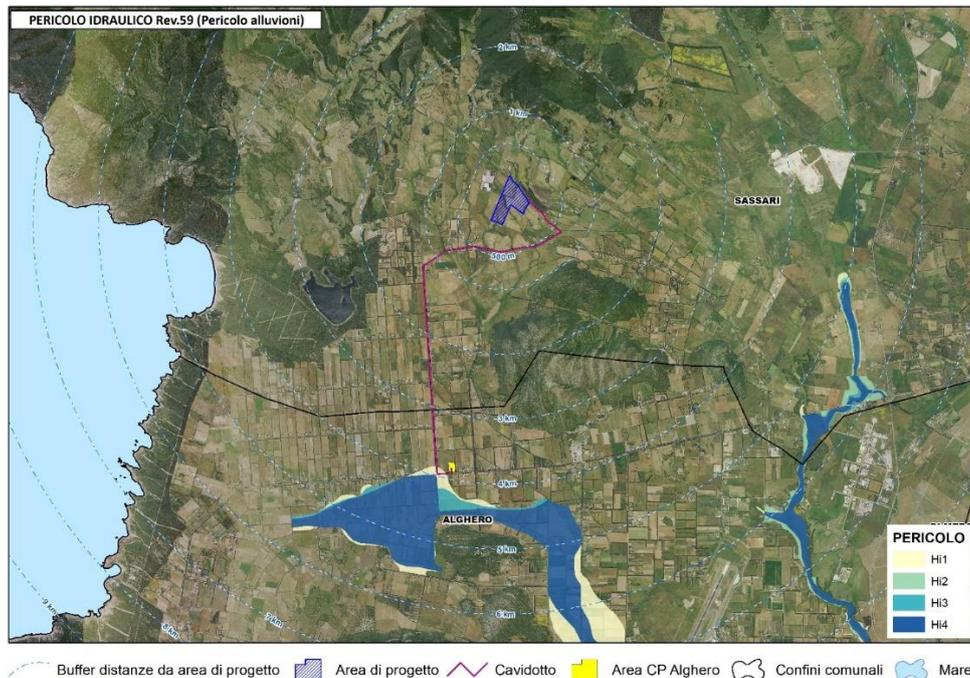
Figura 71: PAI – carta della pericolosità idraulica.
