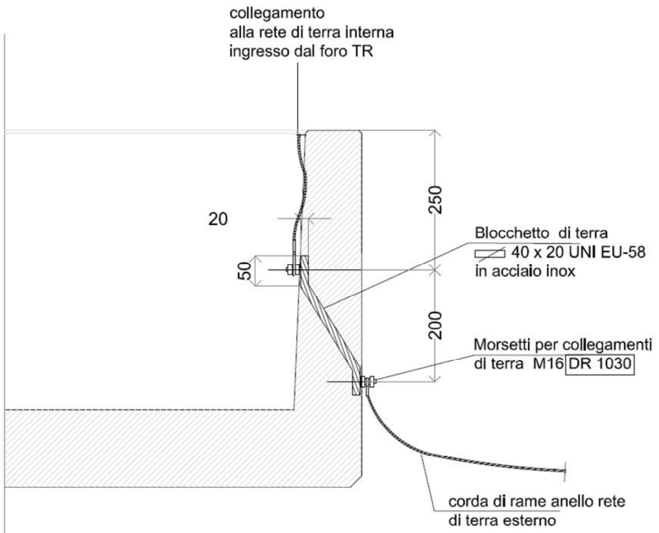
Box in calcestruzzo armato prefabbricato per apparecchiature elettriche per altitudini fino a 1000 metri sul livello del mare.
