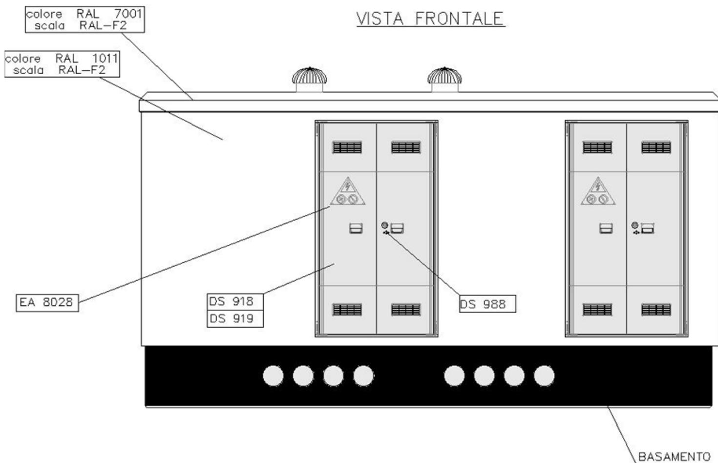
Box in calcestruzzo armato prefabbricato per apparecchiature elettriche per altitudini fino a 1000 metri sul livello del mare.
