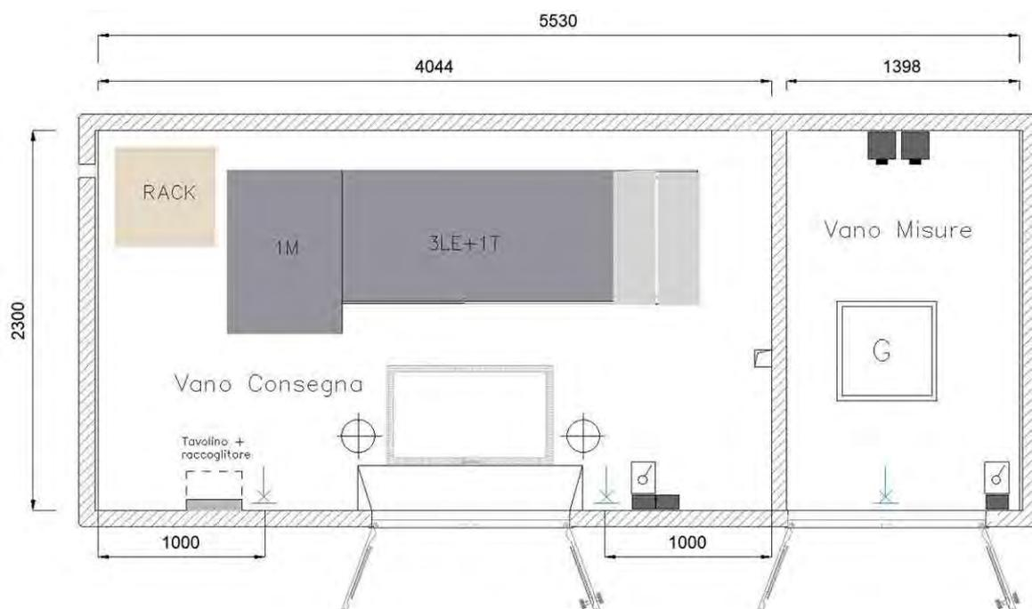
Figura 4 - Pianta dimensionale e funzionale Standard Box Cliente Rid – Ulteriori dimensioni nel §14.4
