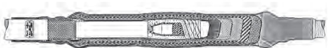
Cavo A: tripolare ad elica visibile con isolamento estruso (ARG7H1RX-12/20 kV o ARE4H1RX-12/20 kV)
