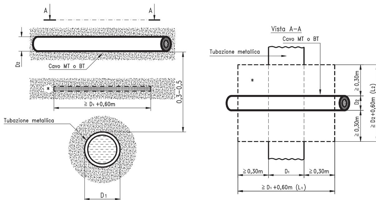
\*elemento separatore rigido in materiale non metallico avente le dimensioni minime  $L_1 = D_1 + 0,60\text{ m}$ ,  $L_2 = D_2 + 0,60\text{ m}$ ; le prescrizioni indicate valgono anche nel caso in cui il cavo di energia incroci inferiormente la tubazione metallica.
