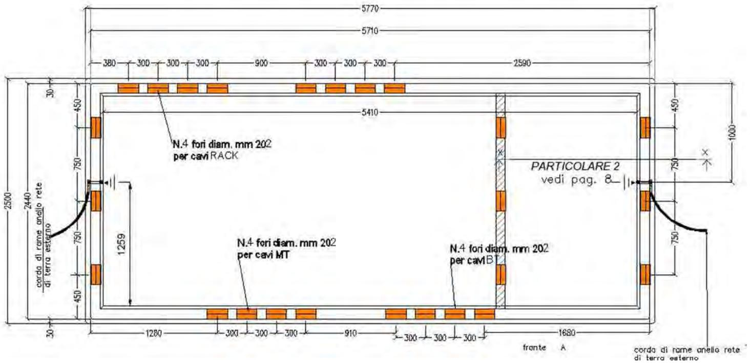
Box in calcestruzzo armato prefabbricato per apparecchiature elettriche per altitudini fino a 1000 metri sul livello del mare.
