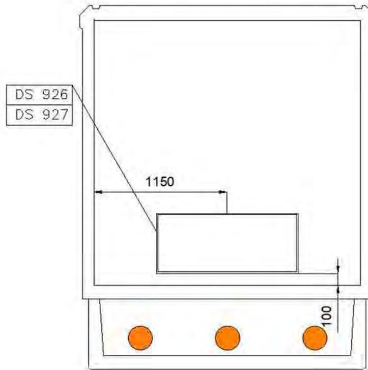
Box in calcestruzzo armato prefabbricato per apparecchiature elettriche per altitudini fino a 1000 metri sul livello del mare.
