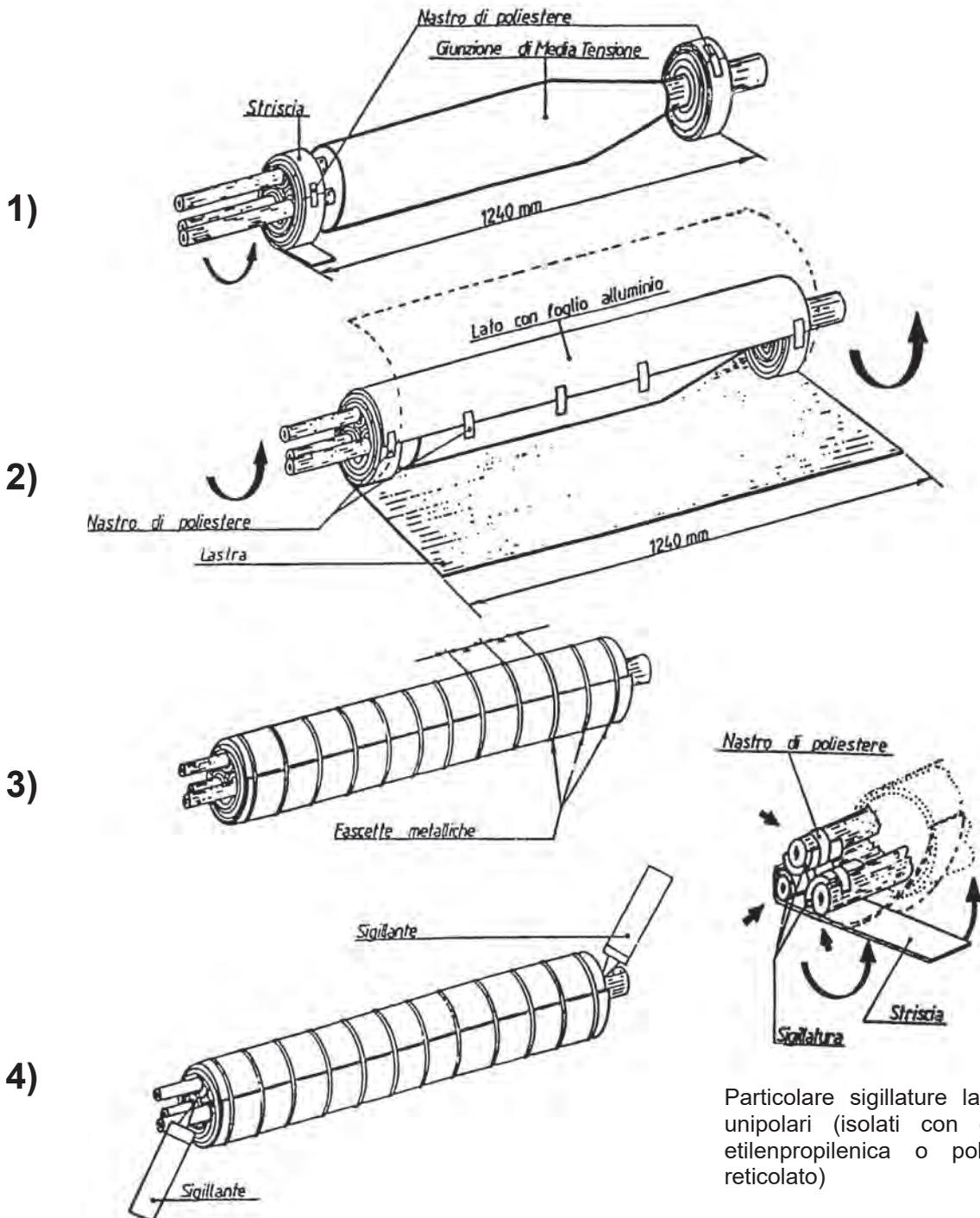
**Giunti diritti unipolari per cavi tripolari ad elica visibile**
