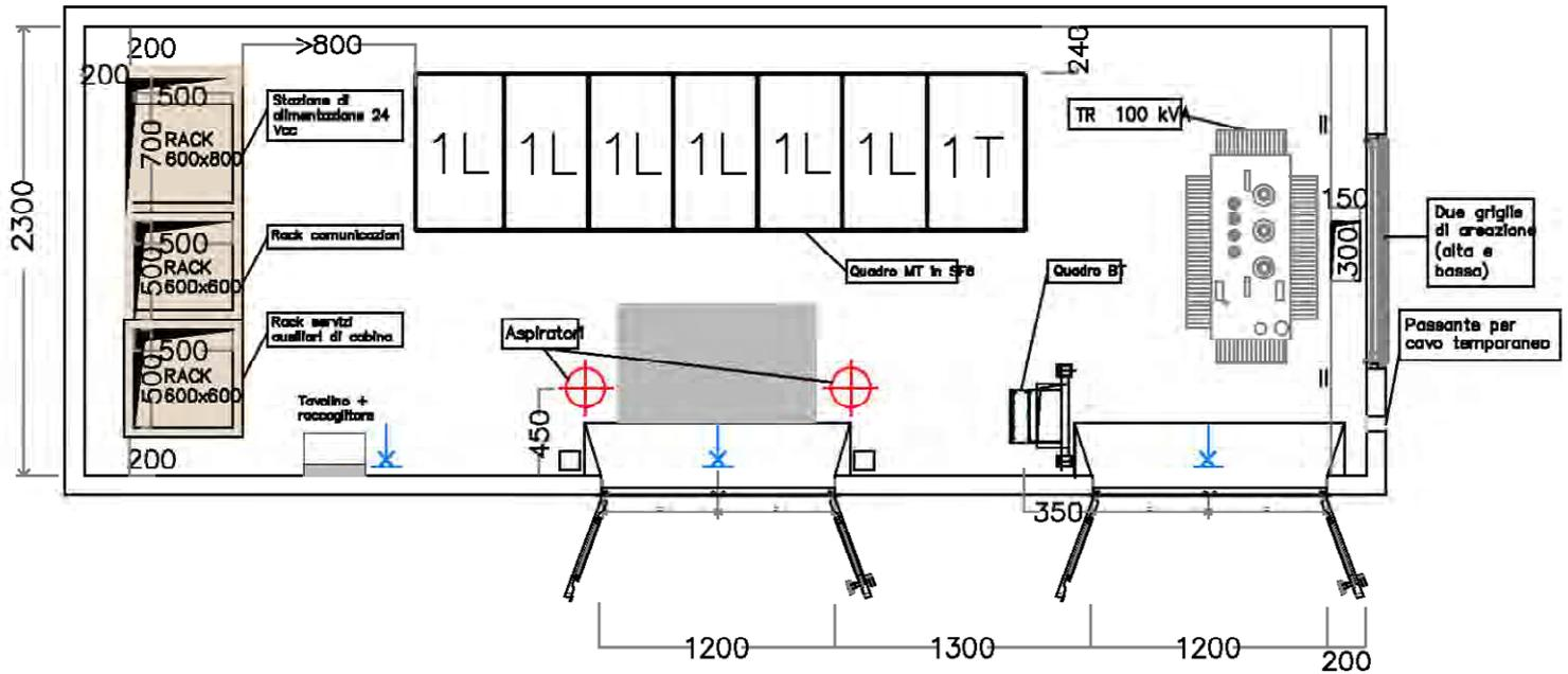
Box in calcestruzzo armato prefabbricato per apparecchiature elettriche per altitudini fino a 1000 metri sul livello del mare.
