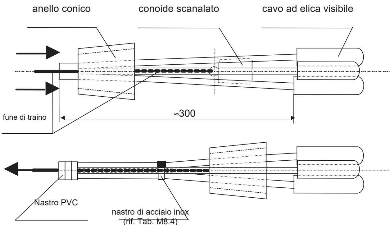
Occorre tenere presente inoltre che per la posa di cavi in presenza d'acqua, al fine di evitare infiltrazioni sotto la guaina esterna o fra i trefoli dei conduttori che nel tempo potrebbero provocare dannose ossidazioni, sarà necessario prevedere una idonea sigillatura fra cavo e dispositivo d'ancoraggio.
