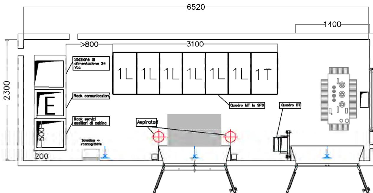
Figura 2 - Pianta dimensionale e funzionale Standard Box Satellite – Ulteriori dimensioni nel §14.2
