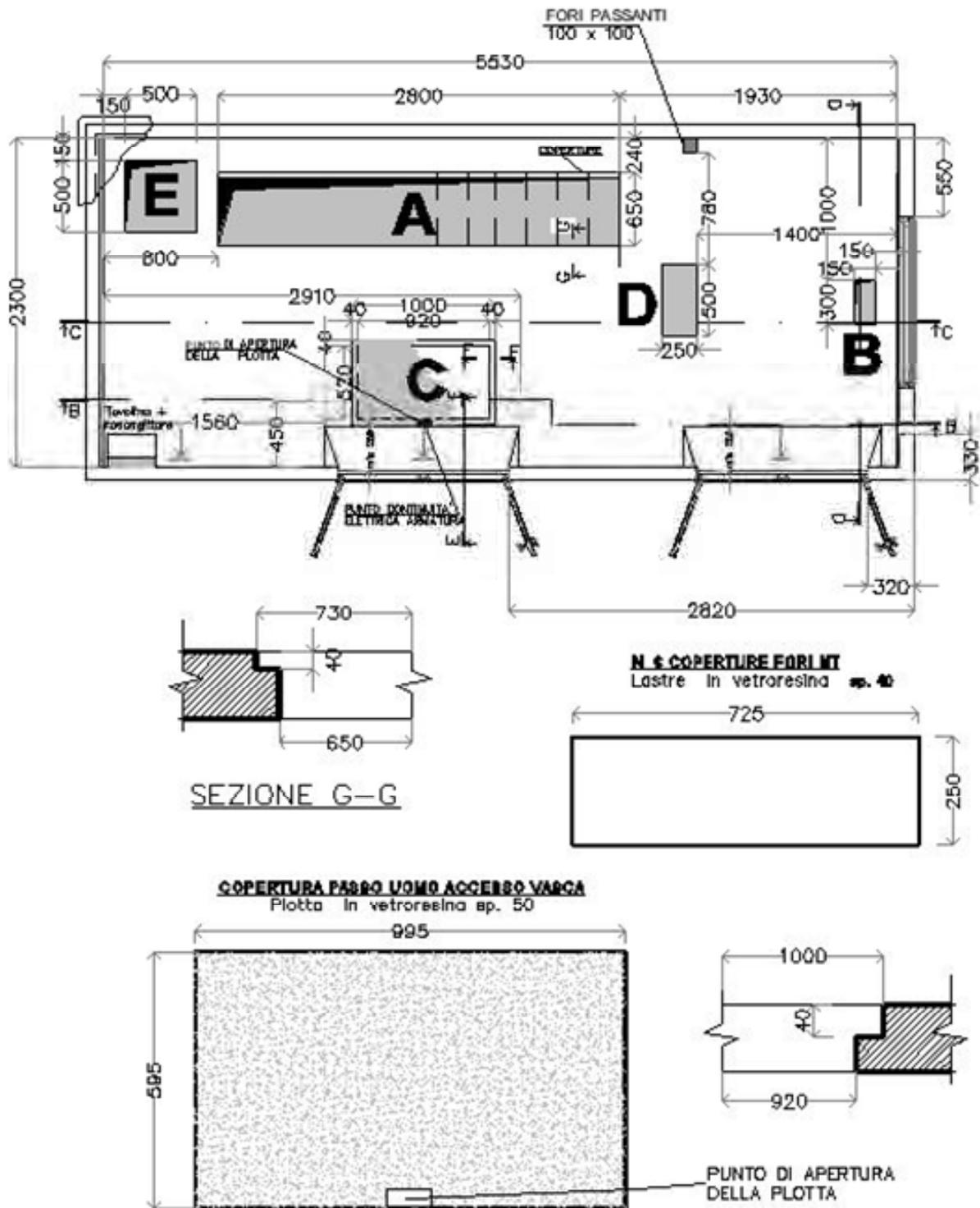
Box in calcestruzzo armato prefabbricato per apparecchiature elettriche per altitudini fino a 1000 metri sul livello del mare.
