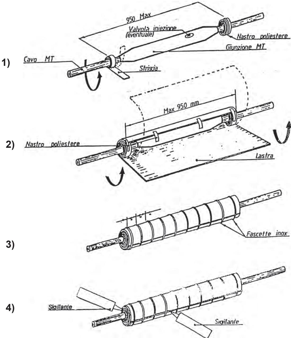
**Esempio di installazione della protezione su un giunto diretto tripolare speciale fra una terna di cavi unipolari ed un cavo cinturato**
