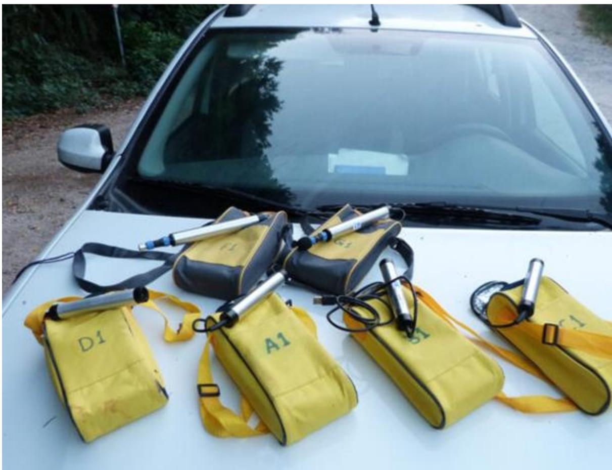
**Figura 10.** L'attrezzatura di rilevamento bioacustico utilizzata per il Monitoraggio della Chiroterofauna nell'Area di Studio vasta (V.Ferri, 2021). Si tratta dei bat-detector Dodotronic Ultramic 384K, utilizzati con programmazione automatica presso le stazioni di rilevamento fisso.
