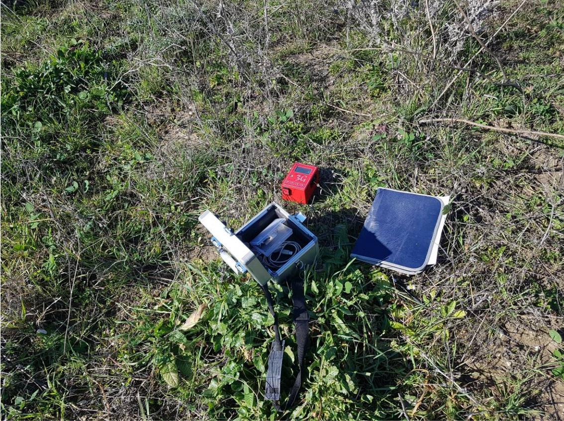
I dati sperimentali ricavate dalle indagini di sismica passiva a stazione singola permettono di ricavare una stima delle velocità delle onde di taglio  $V_s$ .
