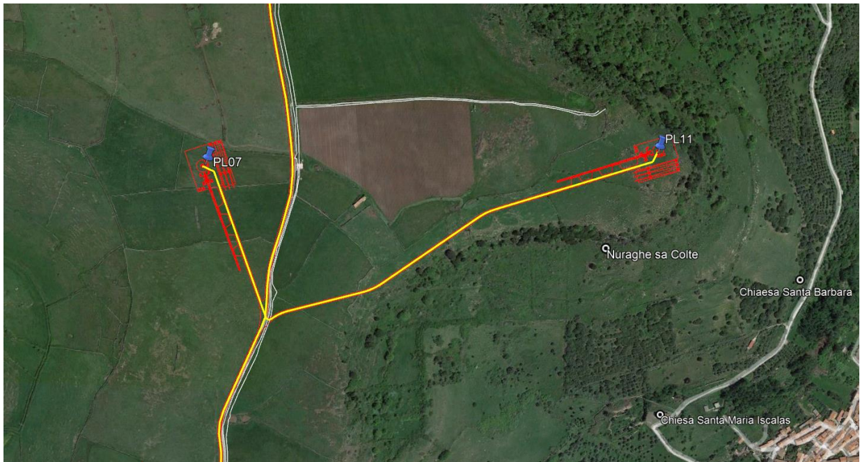
Prima tratta cavidotto analizzato: percorso lungo la sommità del Monte Pelao, che collega gli aerogeneratori PL06 e PL07 e PL11, quest'ultimo con le vicine strutture archeologiche
