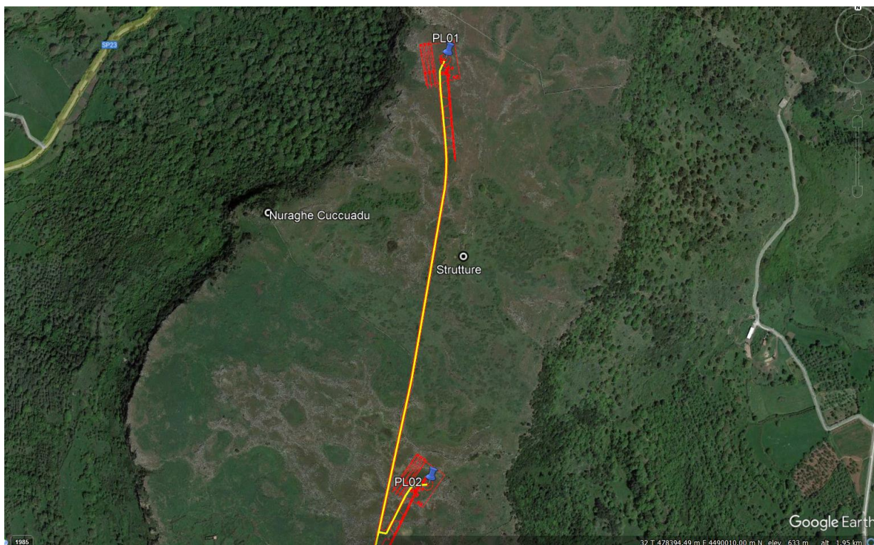
Prima tratta cavidotto analizzato: percorso lungo la sommità del Monte Pelao, che collega gli aerogeneratori PL01 e PL02 con le vicine strutture archeologiche
