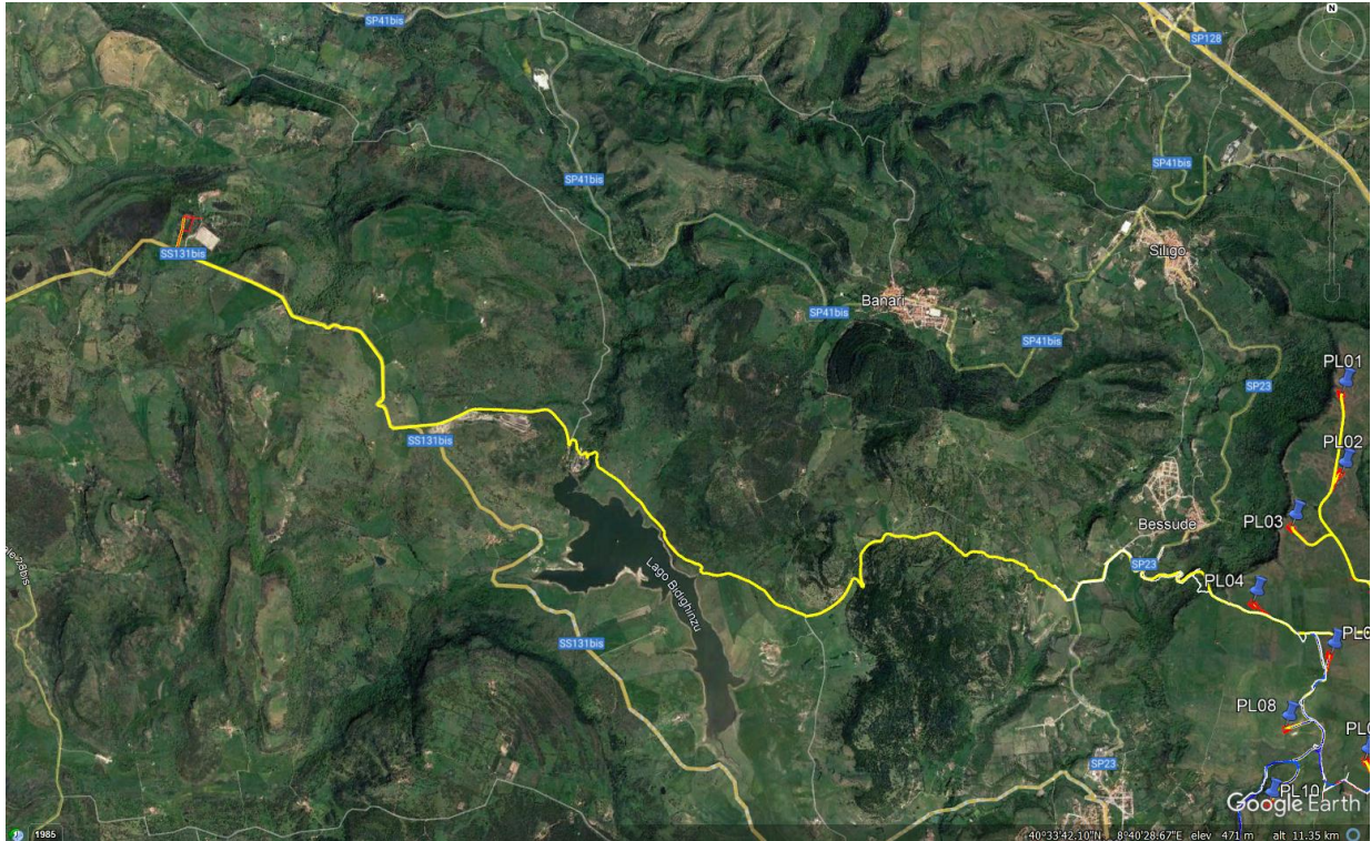
Impianto eolico Monte Pelao, 2° tratta cavidotto: percorso lungo la SP n.23 e la SS 131 bis.
