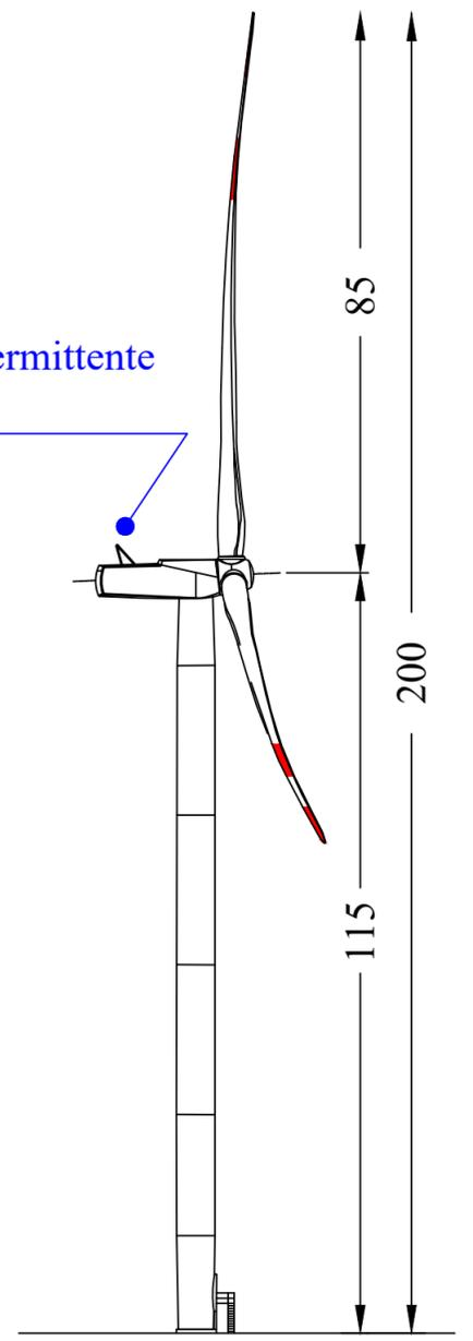
**TUTTI GLI AEROGENERATORI SARANNO PROVVISI DI SEGNALIZIONE CROMATICA (DIURNA) E LUMINOSA (NOTTURNA)**
