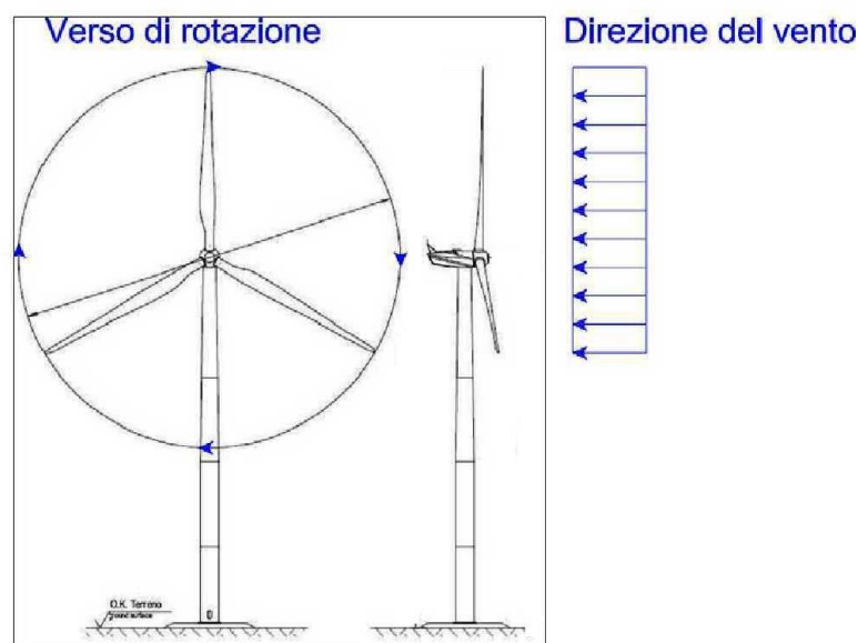
Figura 1: Relazione tra le direzioni del vento ed il verso di rotazione del rotore
