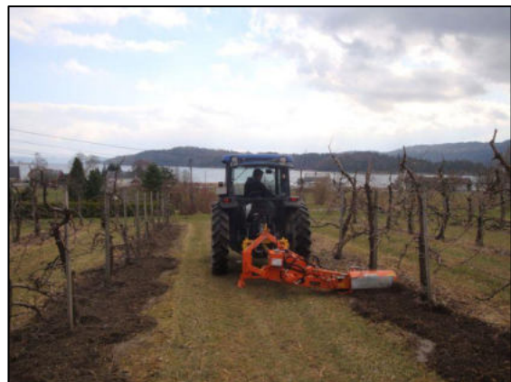
Figura 86 - Esempio di fresatrice interceppo per le lavorazioni sulla fila (Foto: Rinieri S.r.l.)
