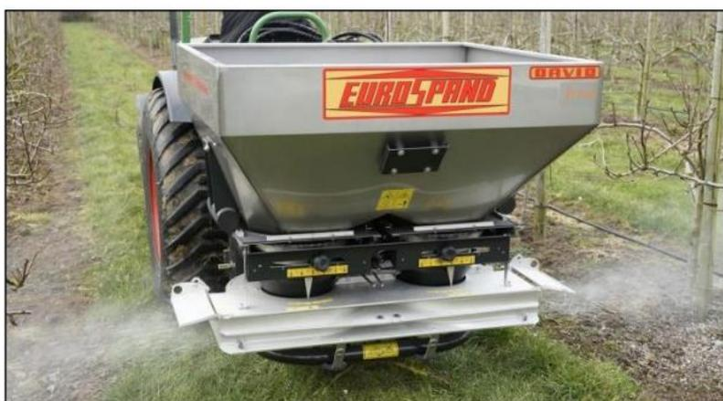
Figura 37 - esempio di spandiconcime localizzato mono/bilaterale per frutteti (Foto: EuroSpand)
