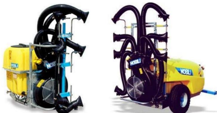
Figura 38 - Esempi di turboatomizzatore portato e trainato con getti orientabili per trattamenti su uno o entrambi i lati del frutteto (Foto: Nobili S.r.l.)
