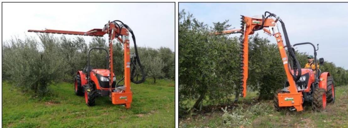
Figura 36 - Esempio di potatrice meccanica frontale a doppia barra (taglio verticale + topping) utilizzabile su tutti le
