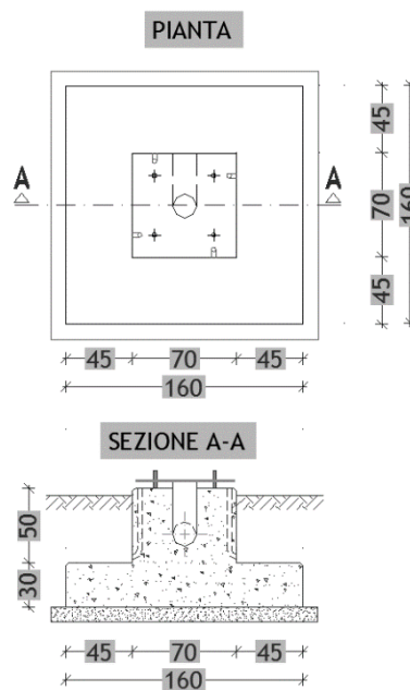
Fig. Pianta e sezione fondazione per terminale cavo AT
