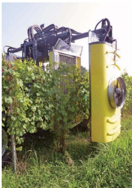
**Foto 4 - pompa irroratrice a polverizzazione pneumatica con diffusore anti-deriva (usata anche per l'oliveto)**
