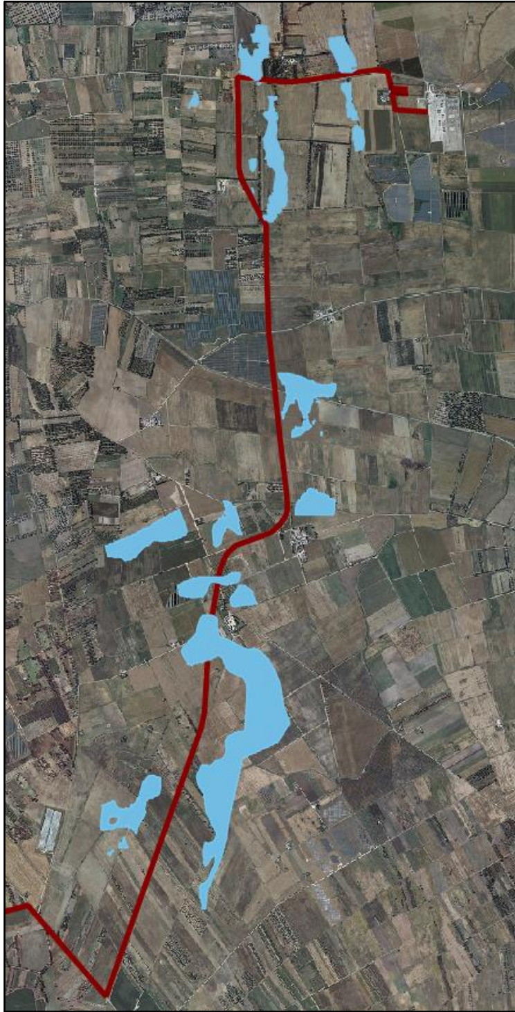
FIG 14C – Perimetrazione aree a pericolosità allagamento T_r=200 anni – Elettrodotto di vettoriamento dell'energia in MT
