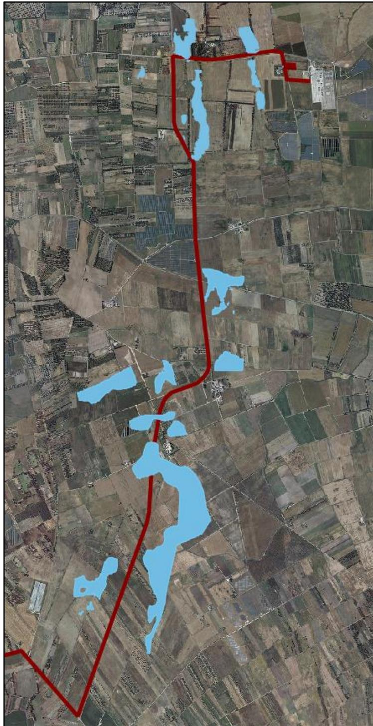
**FIG 21** – Perimetrazione aree a pericolosità allagamento  $T_r=200$  anni – Elettrodotto di collegamento con la Sotto stazione utente (SSU) e l'area di progetto della SSU.
