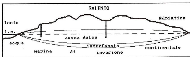
FIG 51 - Sezione idrogeologica schematica della Penisola Salentina
