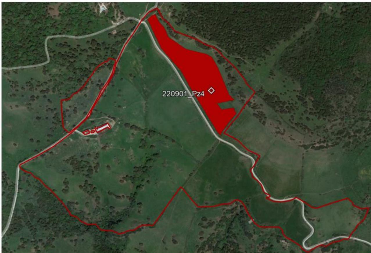
La caratterizzazione dell'area è stata resa possibile dalla realizzazione di un saggio di scavo (220901\_Pz4). Nell'area si rileva la presenza di una copertura terrosa da pedogenesi direttamente poggiata sul basamento lapideo; tra i due strati possono interpersi spessori variabili di depositi eluviali in facies sabbiosa.
