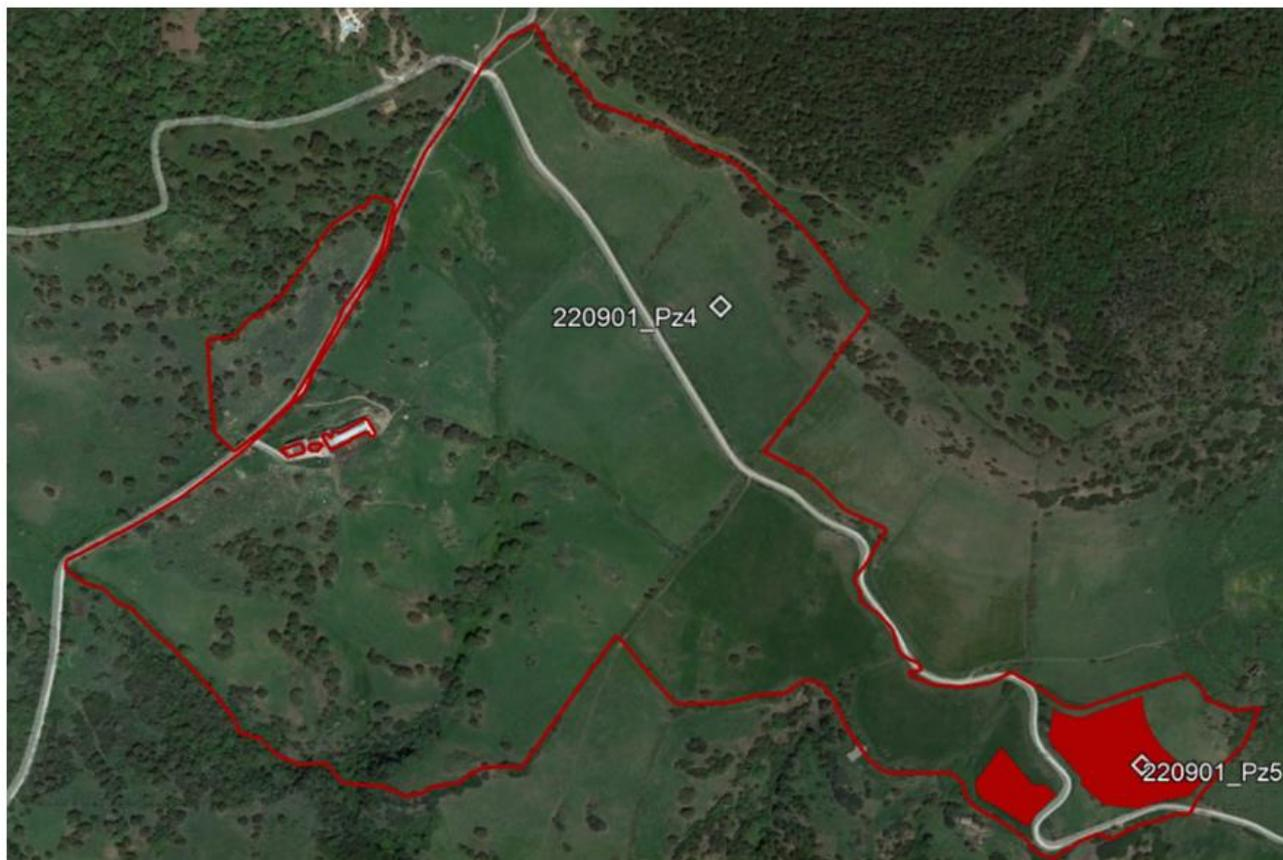
La caratterizzazione dell'area è stata resa possibile dalla realizzazione di un saggio di scavo (220901\_Pz5). Nell'area si rileva la presenza di una copertura terrosa da pedogenesi direttamente poggiata sul basamento lapideo; tra i due strati possono interpersi spessori variabili di depositi eluviali in facies limosa sabbiosa.
