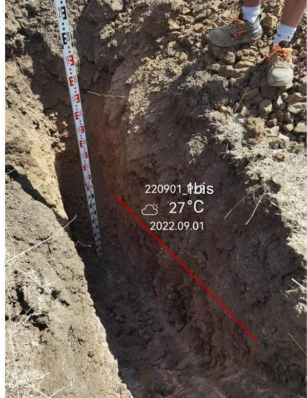
**Foto 3 e 4.: Saggi di scavo 220901\_Pz1 e 220901\_Pz1bis. In evidenza i limiti di strato**
