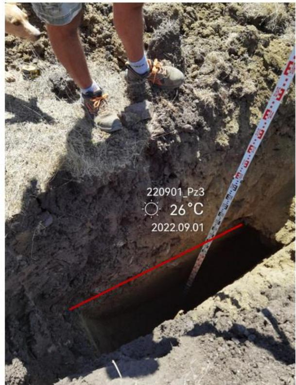
**Foto 5 e 6.: Saggi di scavo 220901\_Pz2 e 220901\_3. In evidenza i limiti di strato**
