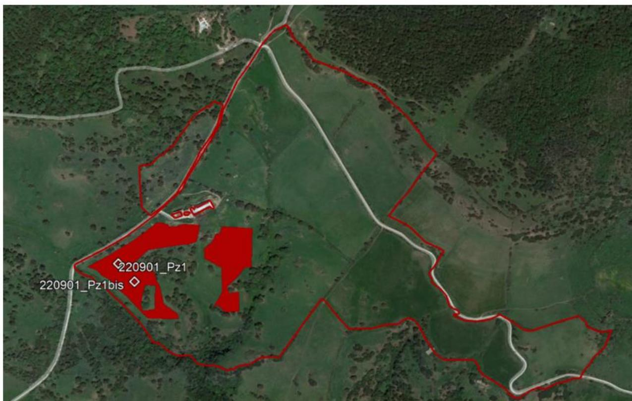
La caratterizzazione dell'area è stata resa possibile dalla realizzazione di due saggi di scavo: 220901\_Pz1 e 220901\_Pz1bis. Nell'area si rileva la presenza di una copertura detritica molto grossolana (ciclopica) con spessore circa metrico sovrapposta, nelle quote più alte, a spessori circa metrici di litologie terrose in facies sabbiosa. Nelle quote più basse una esigua copertura detritica ricopre direttamente il basamento lapideo locale.
