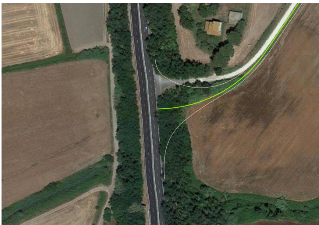
Figura 5.16: Dettaglio su ortofoto dell'immissione della strada secondaria di accesso al gruppo TRQ01-TRQ03-TRQ08 (in verde) sull'Aurelia.
