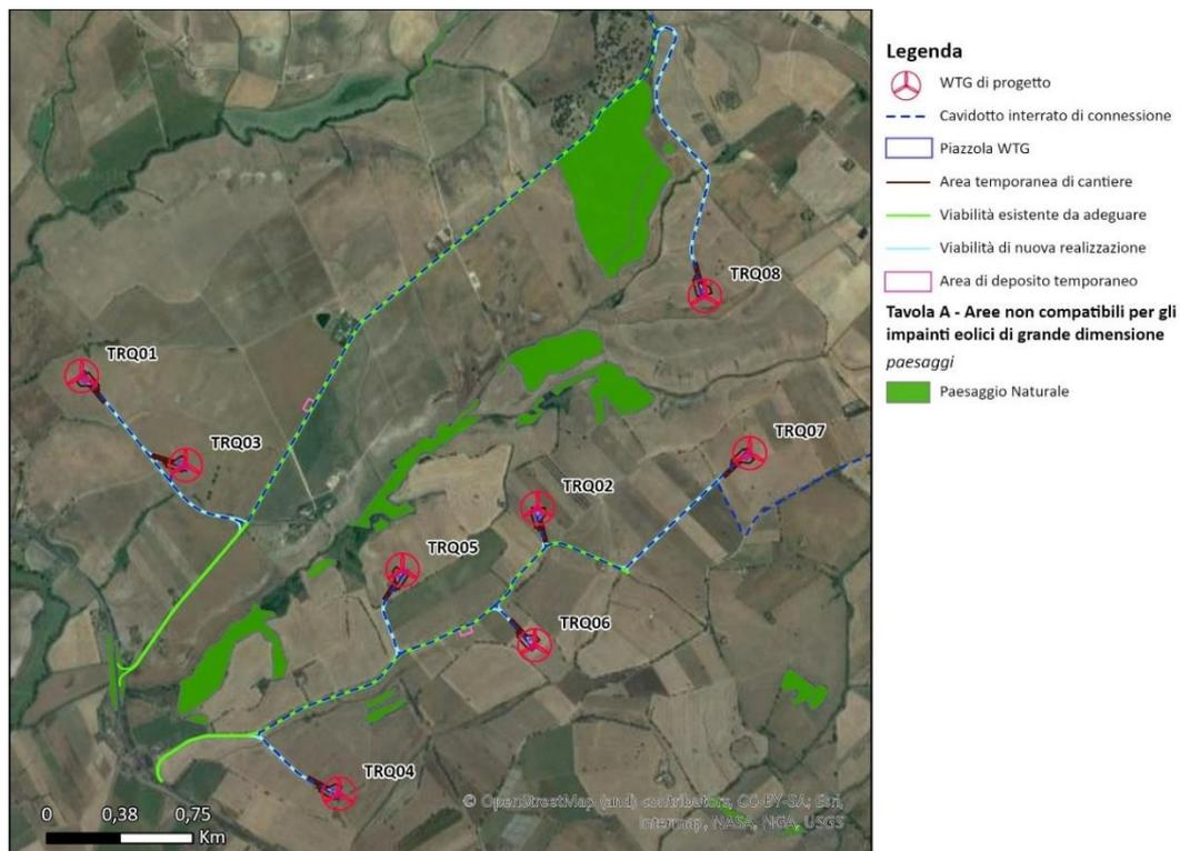
Figura 3-2: Aree non compatibili – Allegato 1 del PTPR, Zoom su layout di progetto
