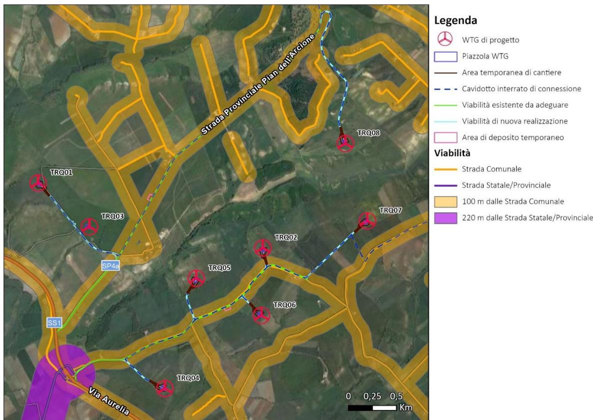
Figura 4-1: Distanze di rispetto dalle infrastrutture della viabilità. Zoom su layout di progetto
