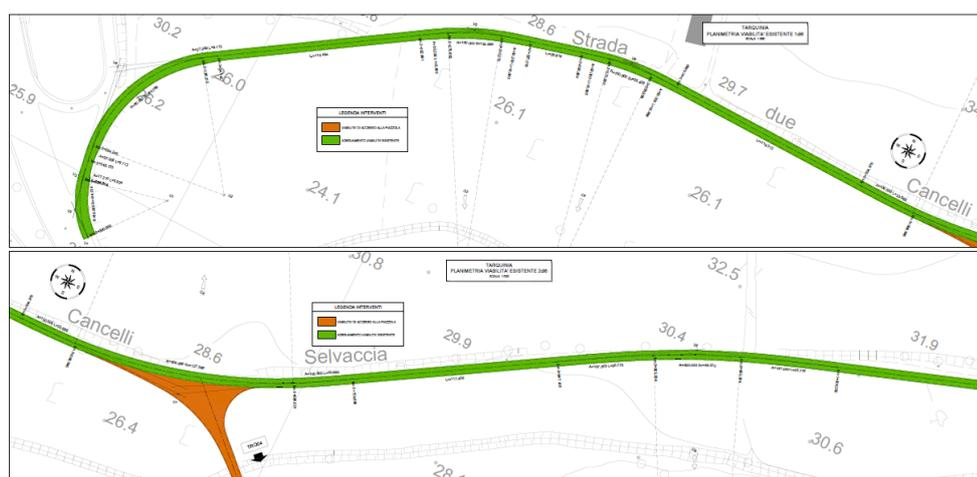
Figura 6-11: Adeguamento viabilità esistente, esempio stralcio planimetrico di progetto – in verde la strada oggetto di adeguamento
