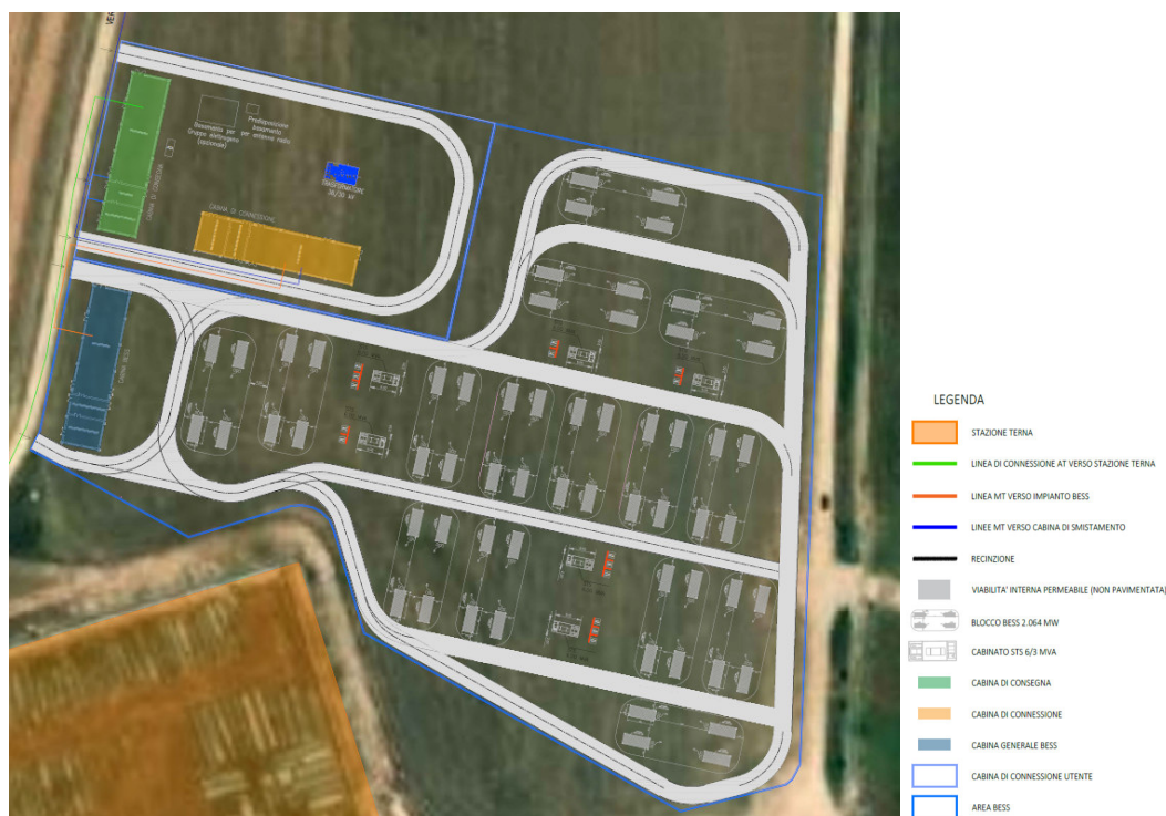
Figura 5.4: Layout dell'unità di accumulo "Wind Farm Tarquinia"
