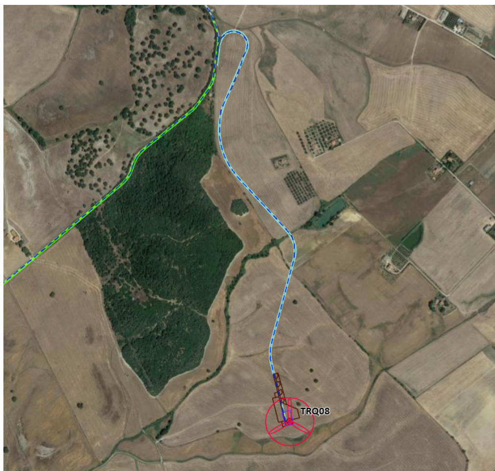
Figura 4.3: Dettaglio su ortofoto dell'immissione della pista (in azzurro) sulla strada secondaria (in verde) per l'accesso alle WTGs TRQ04
