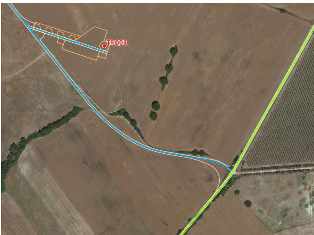
Figura 4.4: Dettaglio su ortofoto dell'immissione della pista (in azzurro) sulla strada secondaria (in verde) per l'accesso alle WTGs TRQ03-TRQ01.
