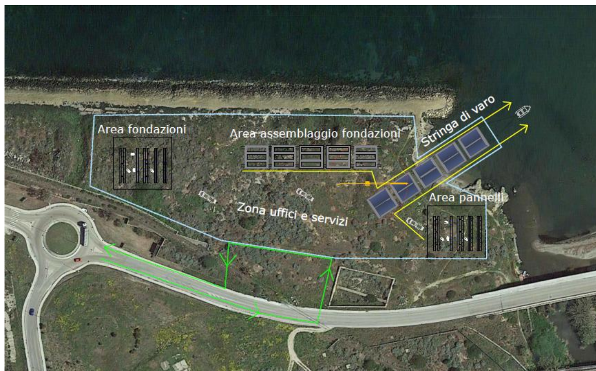
Figura 6.8: Area cantiere a terra e varo dei moduli fotovoltaici
