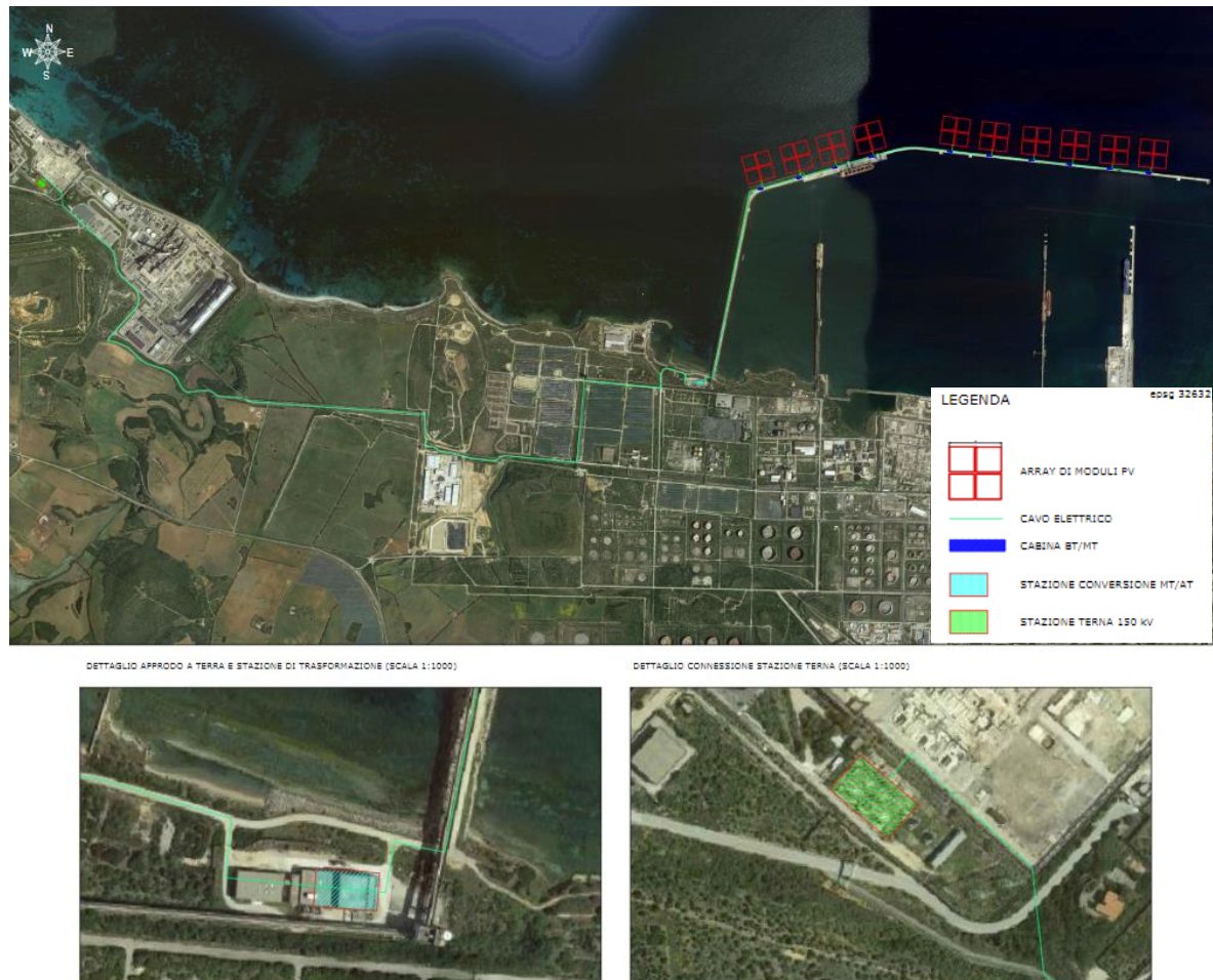
Figura 1-1: Inquadramento su ortofoto dell’impianto fotovoltaico roff-shore
