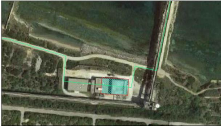
Figura 4-7: Dettaglio del tracciato dell'elettrodotto a terra – sottostazione di trasformazione MT/AT
