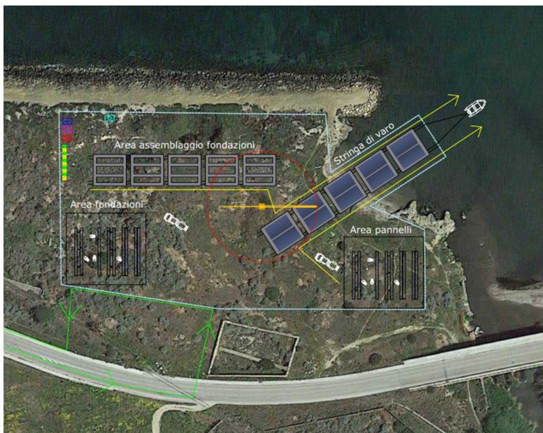
Figura 4-11: Area cantiere a terra e varo dei moduli fotovoltaici
