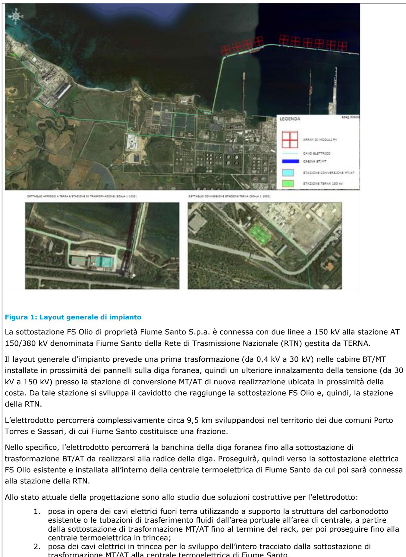
Il tracciato dell'elettrodotto si svilupperà al margine laterale della viabilità esistente; pertanto, non verrà consumato suolo allo stato naturale. Con riferimento all'attraversamento del Fiume Santo, esso verrà realizzato ancorando l'elettrodotto al viadotto esistente. Nel caso in cui tale soluzione non sia percorribile si provvederà alla posa dell'elettrodotto in trincea mediante perforazione orizzontale controllata
