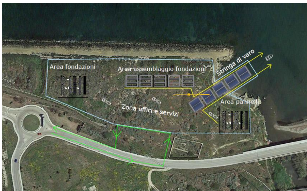
Figura 59: Area cantiere a terra e varo dei moduli fotovoltaici
