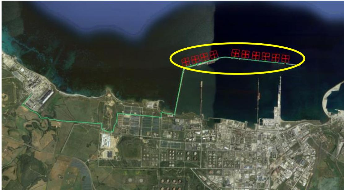
**Figura 4-1: layout generale di impianto, incluso cavidotto. In rosso le 'isole' di circa ha 3,0 in forma di 10 moduli galleggianti di 180x180m ciascuna per una superficie complessiva di circa ha 30,0 ha**
