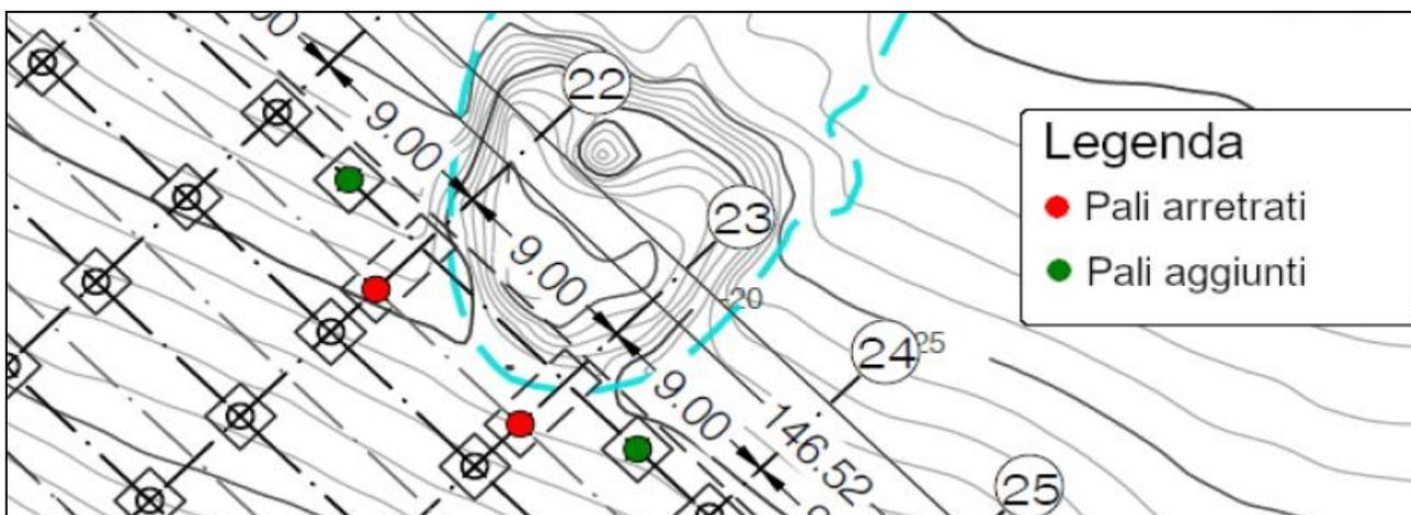
Figura 16: Dettaglio della soluzione adottata per risolvere l’interferenza tra l’opera di progetto e il relitto
