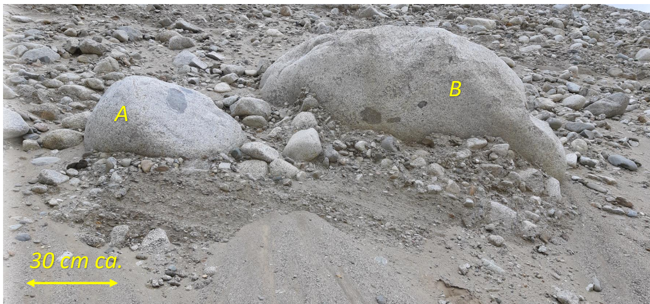
Figura 25: dettaglio dei depositi alla base della scarpata laterale alla posizione dell'imbocco della galleria naturale di Finestra Forch, con in evidenza due blocchi di granito sub arrotondati di dimensioni da pluridecimetriche (A) a metriche (B).
