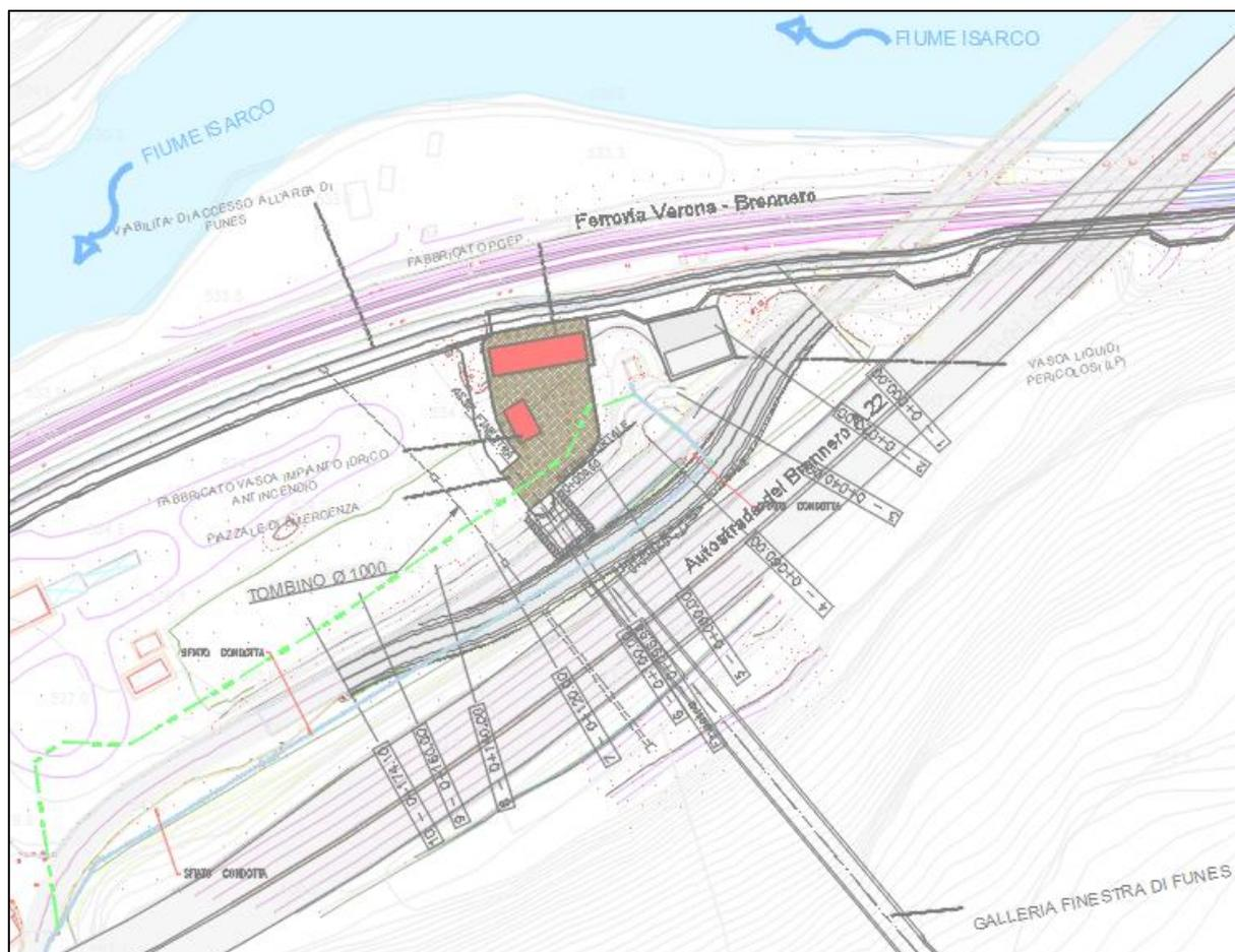
Fig. 1 - Area d'intervento della Finestra di Funes con indicata la deviazione provvisoria della viabilità S.P. 242
