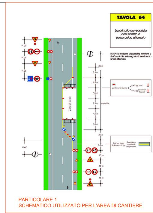
PARTICOLARE 1 SCHEMATICO UTILIZZATO PER L'AREA DI CANTIERE
